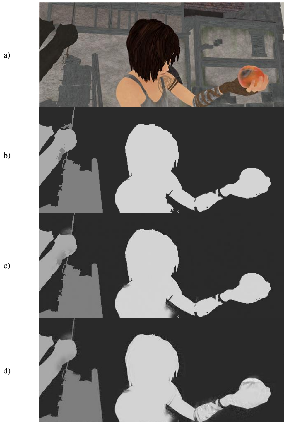
Abbildung 6.15: a) Frame des Eingabevideos. b) Ergebnis nach der Segmentierung (Disparitätskarte). b) Ergebnis nach der Regularisierung ( r = 4 , r_t = 9 , \varepsilon = 0.0016 ). c) Ergebnis nach der optionalen Nachbearbeitung ( r = 2 , r_t = 1 , \varepsilon = 0.00016 ).
