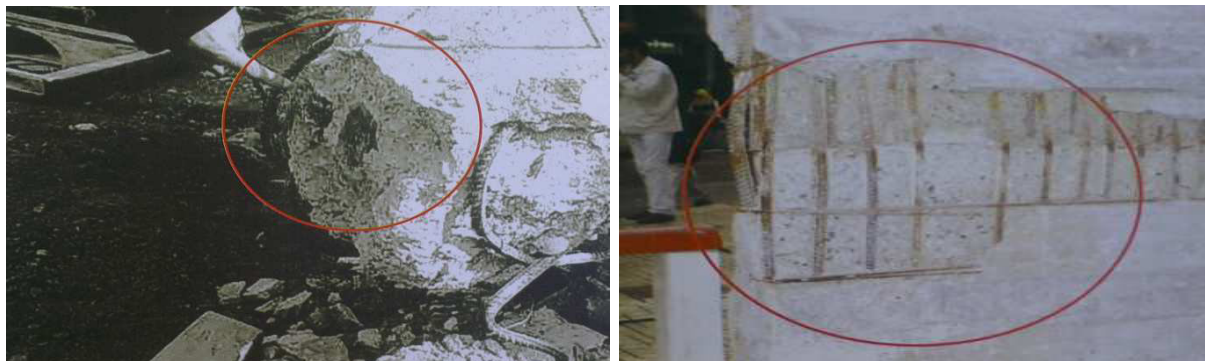
Abbildung 24: Gesteinskörner mit einem Durchmesser von 10 cm (links); mangelhafte Bewehrung einer Wandscheibe (rechts) [22]
