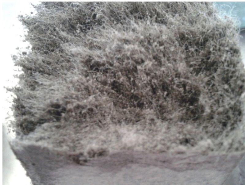
Abbildung 84 – Vollständiger Faserauszug beim SHCC V8mod, Prantl 2014
