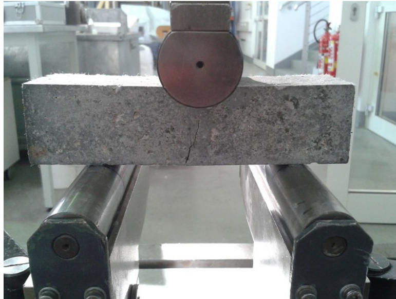
Abbildung 72 – PP – Faserbeton VV4 im Biegeversuch, Prantl 2014
