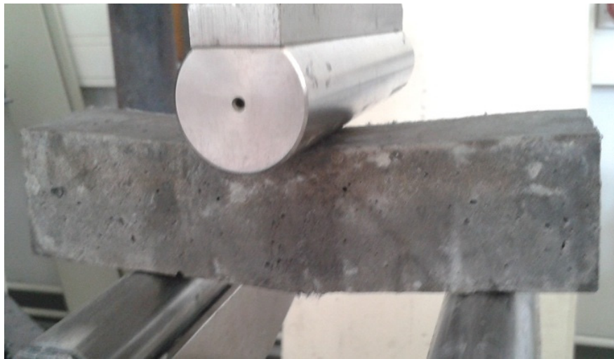
Abbildung 88 – Duktileres Verhalten beim Biegezugversuch mit PE-SHCC V8mod, Prantl 2014
