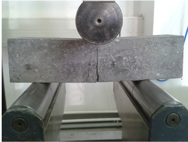
Abbildung 75 – PP – Faserbeton VV3 im Biegeversuch, Prantl 2014
