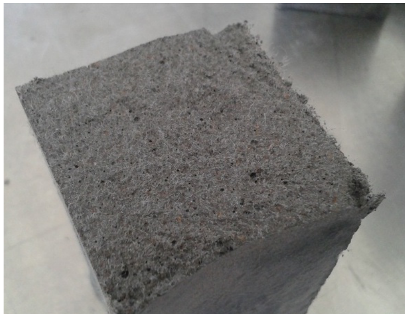
Abbildung 81 – Bruchfläche des PE-SHCC V7mod nach dem Biegeversuch, Prantl 2014
