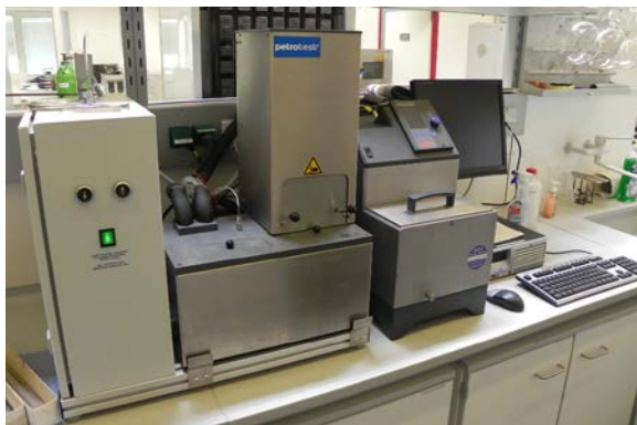
Abbildung 46: links: Bending Beam Rheometer, rechts: Bitumenbalkenform
