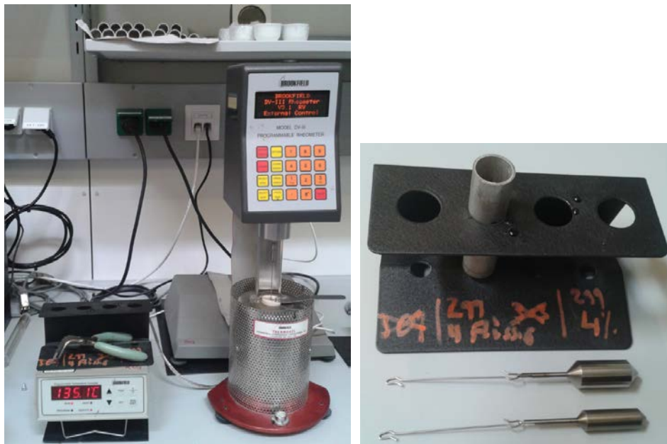
Abbildung 36: links: Rotational Viscometer, rechts: Aluminiumhülse und Spindeln
