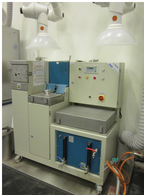
Abbildung 22: Asphaltanalysator der Fa. Infratest, Model: ecoTest
