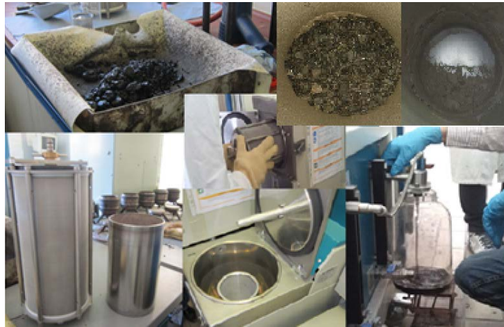
Abbildung 23: Ablauf der Extraktion von Asphaltmischgut
