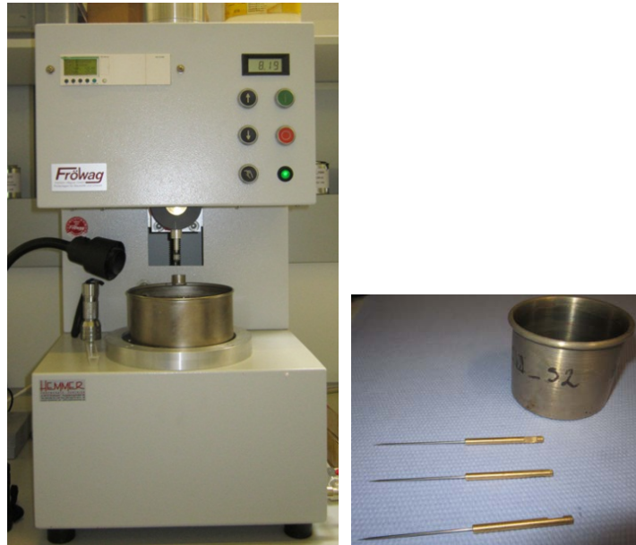
Abbildung 28: links: Nadelpenetrometer, rechts: Penetrationsnadel und -tiegel
