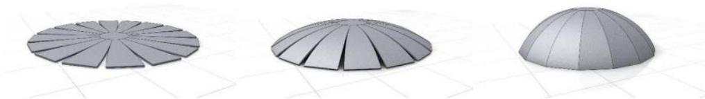
**Abbildung 1.13: Umformungsprozess von einer ebenen Betonplatte zu einer zweifach gekrümmten Schale [1]**
