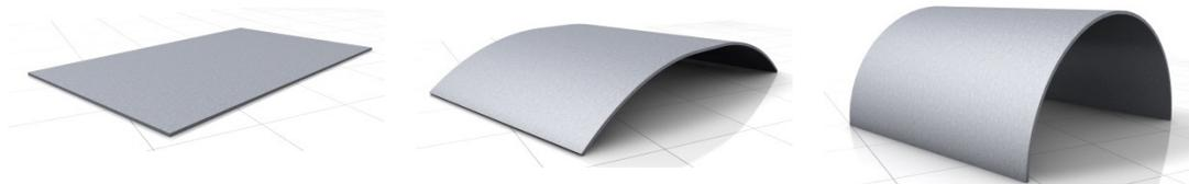
Abbildung 2.34: : Umformungsprozess Zylinder [4]
