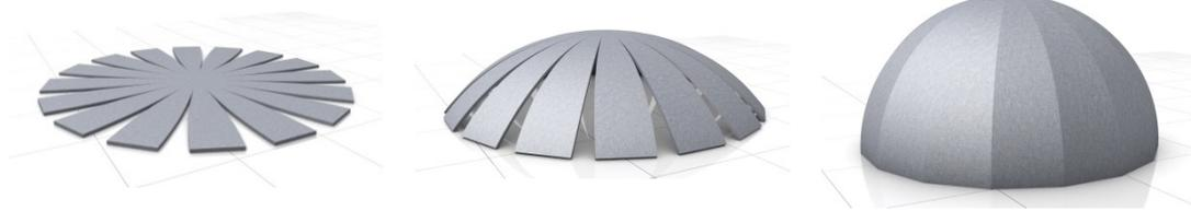
Abbildung 2.17: Umformungsprozess Halbkugel [9]
