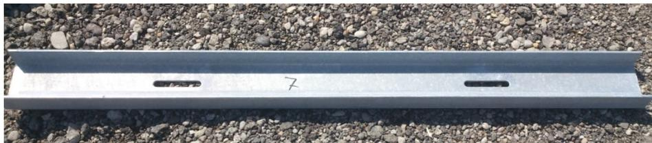
Abbildung 3.5: Querverschubsicherung
