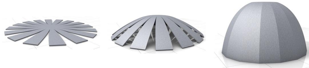
**Abbildung 2.57: : Umformungsprozess Paraboloid [4]**
