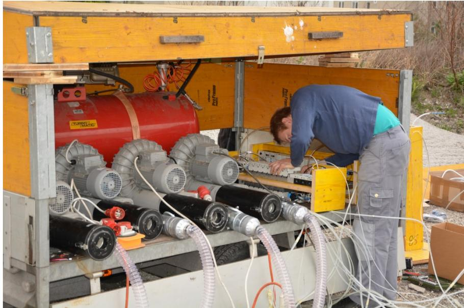
**Abbildung 3.20: angeschlossene Luftschläuche an Seitenkanalverdichter und Ventilinsel**
