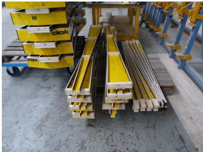
Abbildung 1.17: keilförmige Abschalelemente
