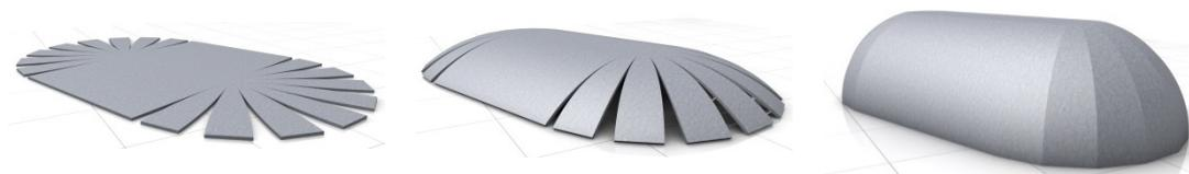
Abbildung 2.36:: Umformungsprozess Zylinder in Kombination mit 2 Halbkugelabschnitten [4]
