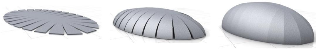
Abbildung 2.41: Umformungsprozess Halbellipsoid [4]
