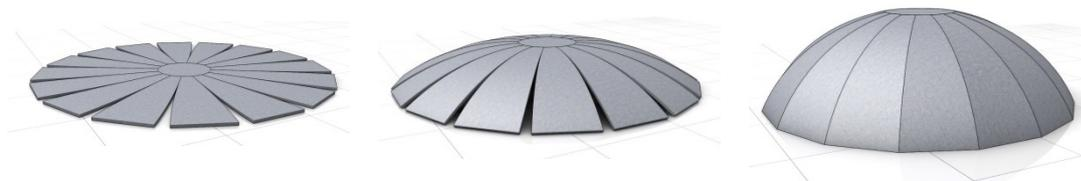
**Abbildung 2.22: Umformungsprozess Kugelabschnitt [4]**
