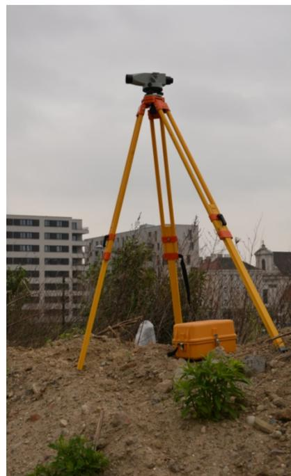
**Abbildung 3.22: Höhenmessung mit Nivelliergerät**
