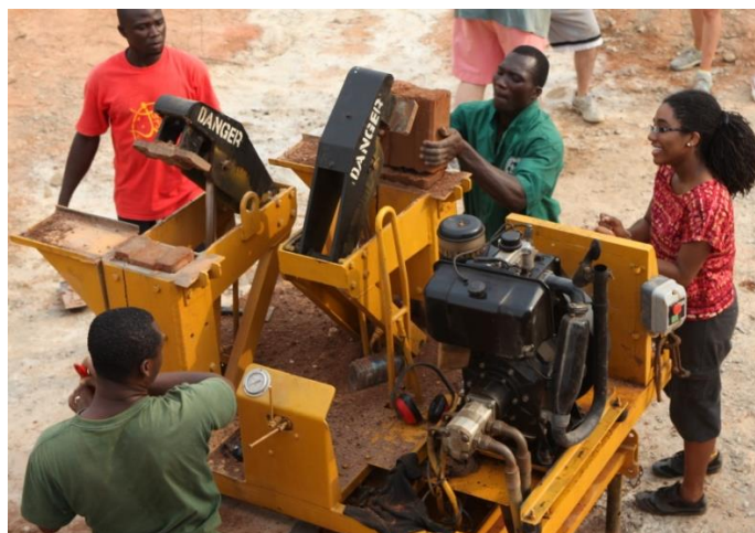
Abbildung 20: Hydraform Ziegel Herstellung [24]
