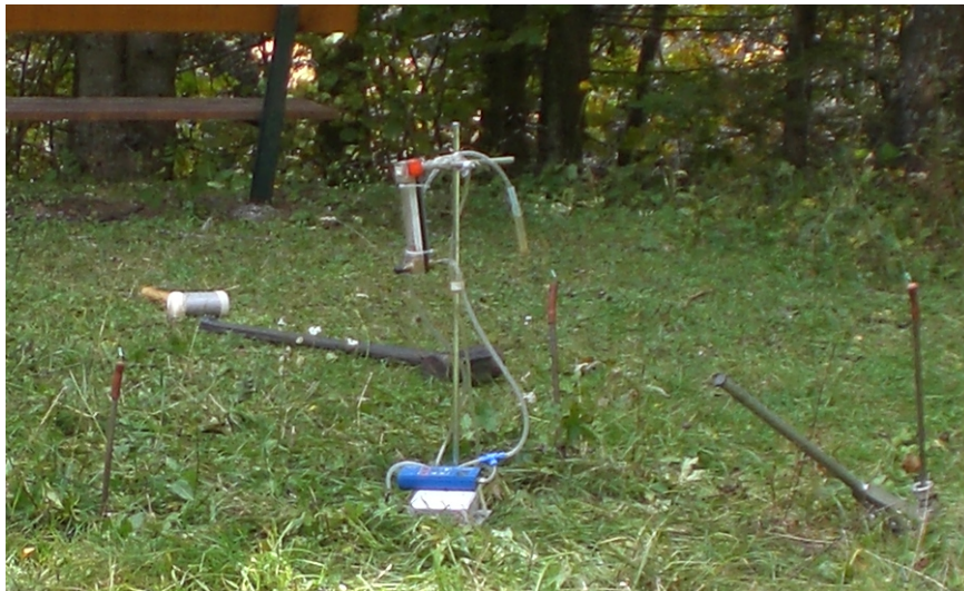
Abbildung 6.1.: Geräteaufbau zur Permeabilitätsmessung.
