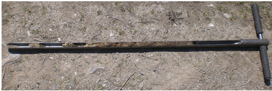
Abbildung 7.2.: Gewonnene Probe mittels Stechbohrer.
