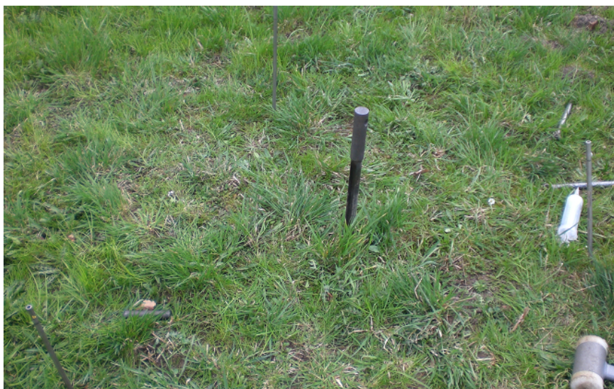
Abbildung 7.1.: Stechbohrer beim Einschlagen.
