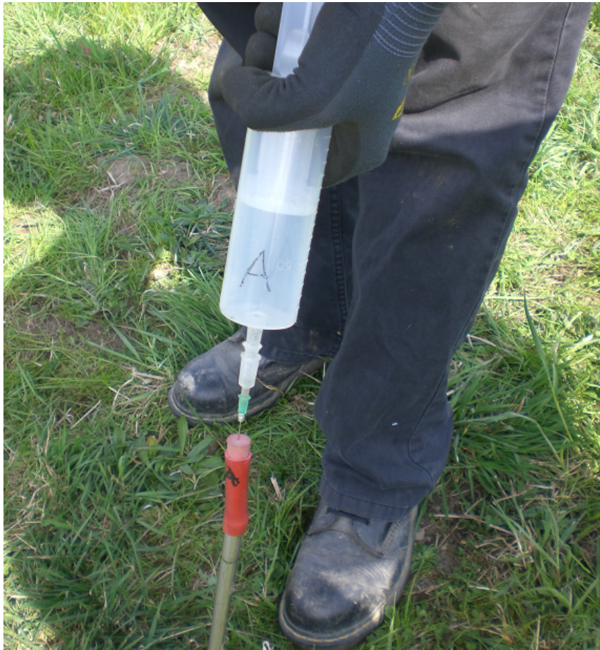
Abbildung 5.2.: Extraktion der Bodenluft.
