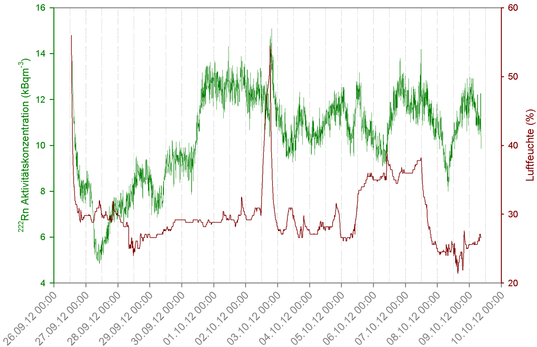
Abbildung D.1.: Zeitliche Verlauf der ^{222}\text{Rn} Radon-Aktivitätskonzentration und der Luftfeuchtigkeit an Messort 40.
