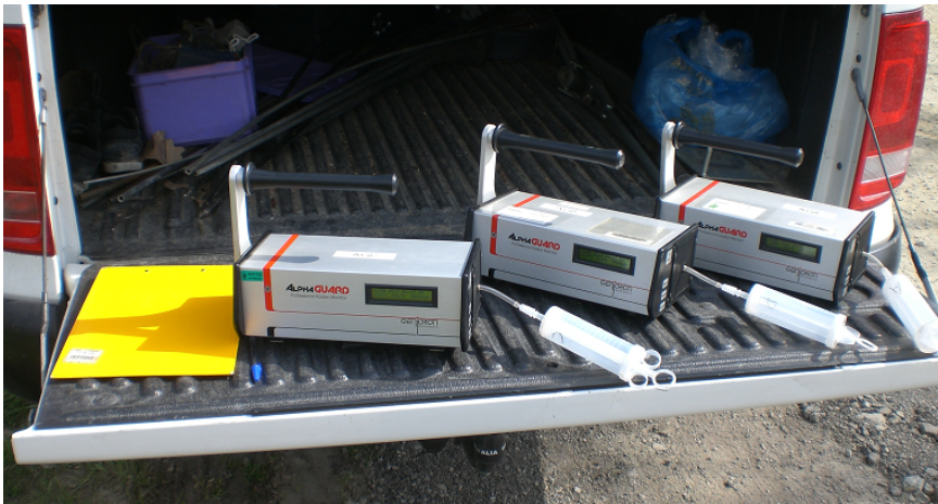
Abbildung 5.3.: Alphaguards mit angesteckten Spritzen während einer Messung.
