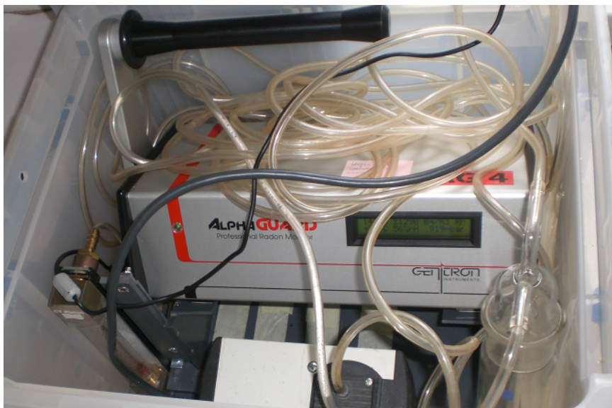
Abbildung 5.4.: System zur Langzeitmessung.
