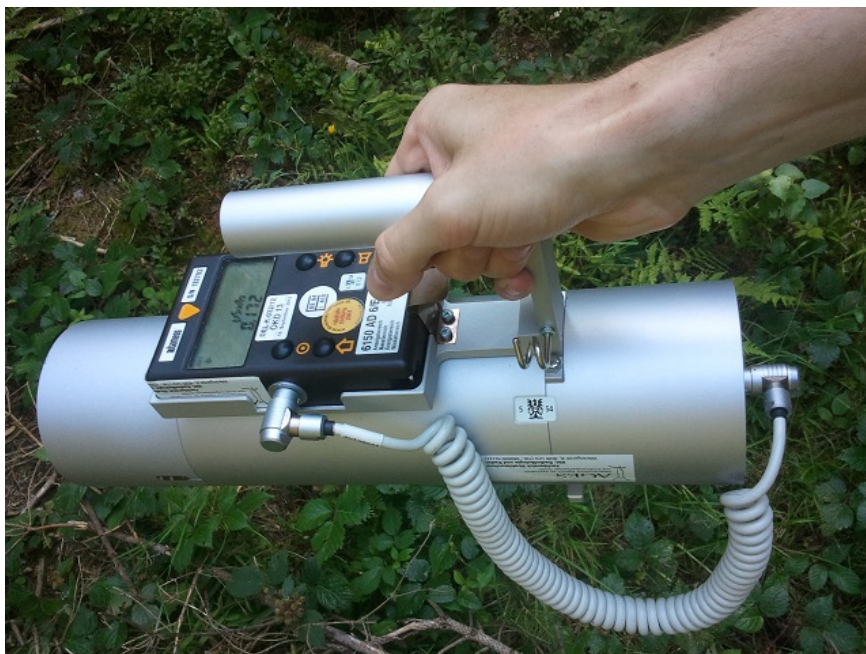
Abbildung 7.3.: Die Szintillatorsonde bei der Messung.
