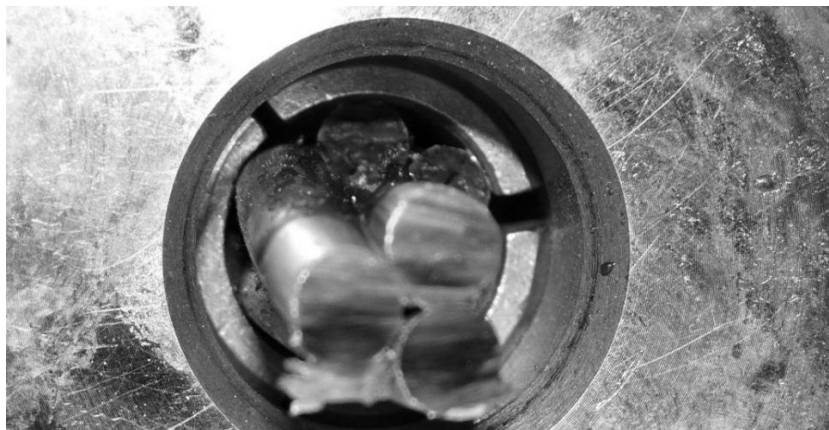
Mischbrüche (cup-cone fracture) an der vordersten Keilrille
