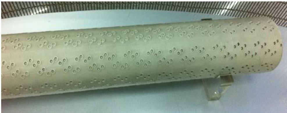
Abb. 4: Profilierung eines Hüllrohrs
