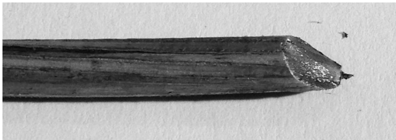
Scherbruch an der vordersten Keilrille
