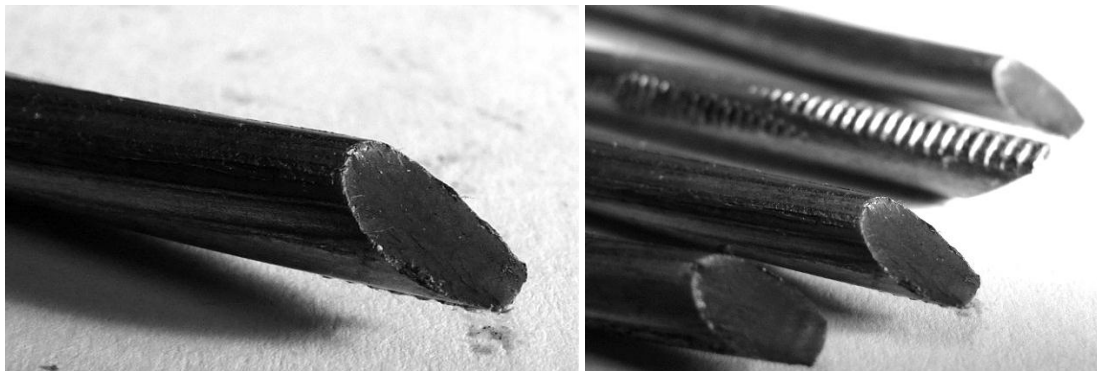
Scherbrüche im Verankerungsbereich
