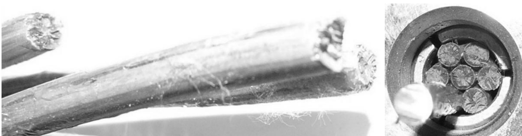
Mischbrüche (cup-cone fracture) an der vordersten Keilrille
