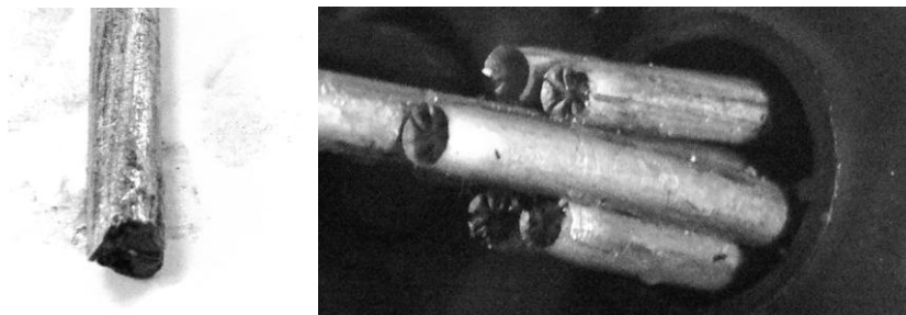
Ermüdungsbruch (li); Mischbrüche (cup-cone fracture) (re)
