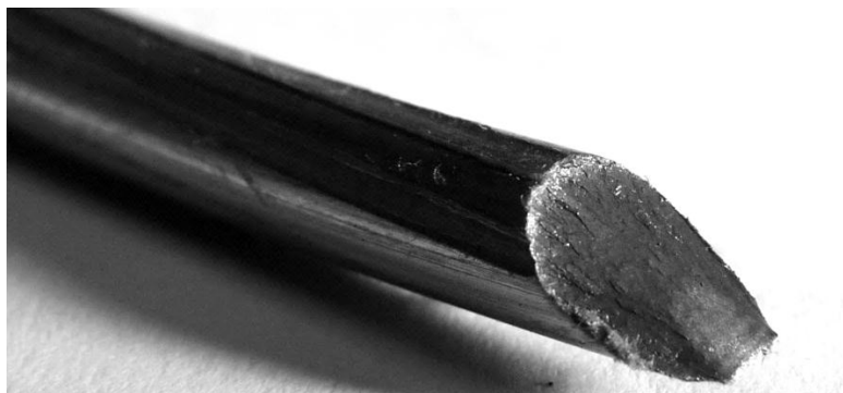
Scherbruch an der vordersten Keilrille
