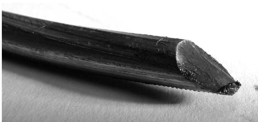
Scherbruch an der vordersten Keilrille
