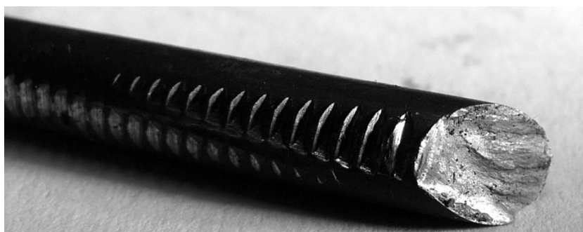
Scherbruch im Verankerungsbereich
