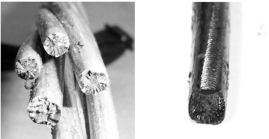
Abb. 43: Ermüdungsbruch (unten) und Trichterbrüche (oben) (li); Ermüdungsbruch (re)
