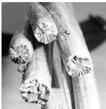
Ein Ermüdungsbruch (li unten) und drei Mischbrüche (li oben); Scherbruch (re)
