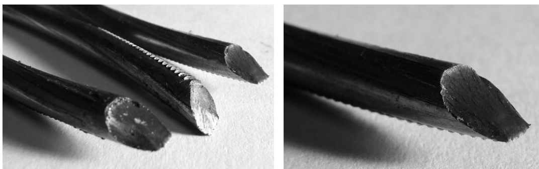
Scherbrüche an der vordersten Keilrille
