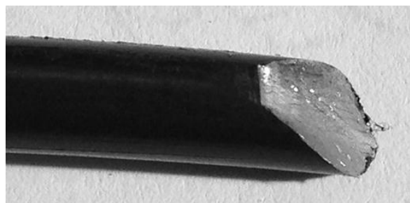
Scherbruch an der vordersten Keilrille
