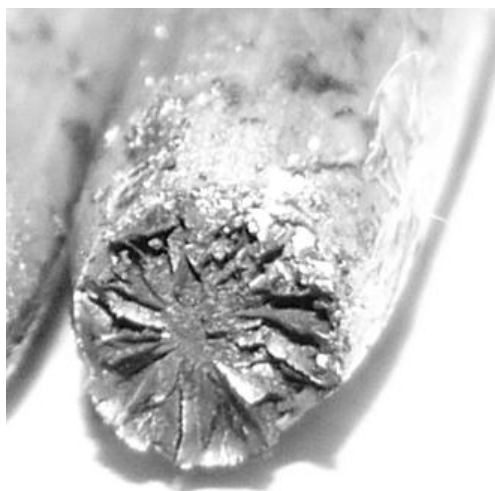
Abb. 29: Typischer Mischbruch (cup-cone fracture)
