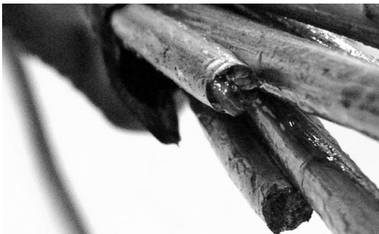
Mischbrüche (cup-cone fracture) an der vordersten Keilrille
