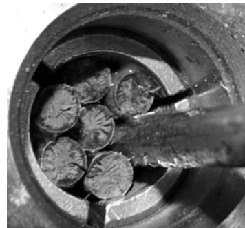
Mischbrüche (cup-cone fracture) an der vordersten Keilrille
