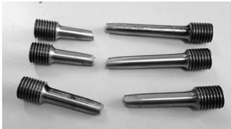
Abb. 71: Rundzugproben mit Gewindeköpfen
