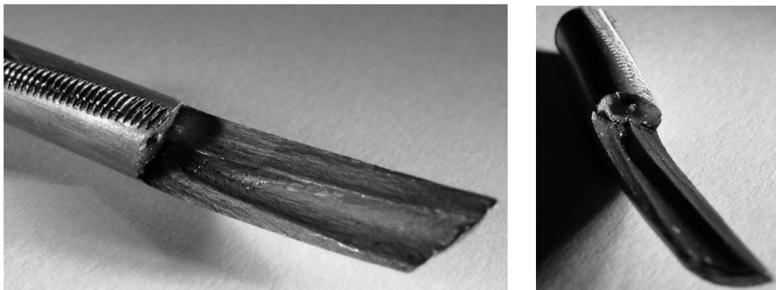
Abb. 33: Ermüdungsbruch, der zu einem Abgleiten des restlichen Drahtquerschnitts führte
