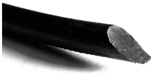
Scherbruch an der vordersten Keilrille
