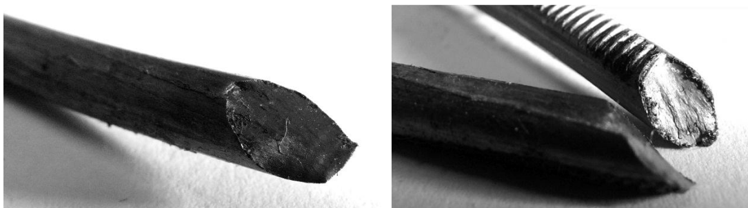
Scherbrüche im Verankerungsbereich
