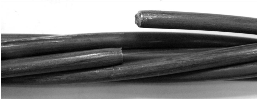
Drahtbruch in der freien Länge des Kabels
