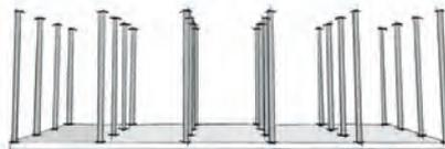
stahlstützen, durchmesser 20cm
