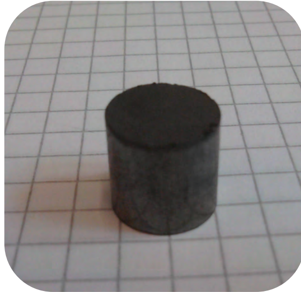
Abbildung 2.15.: Erfolgreicher Pressversuch von Hydroalloy mit 12.5 Gew.% ENG gepresst mit einem Pressdruck von 100 MPa. 1 Kästchen entspricht 0.5 cm.
