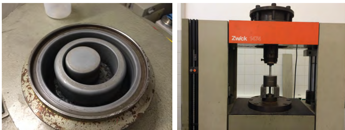
Abbildung 2.14.: Scheibenmühlenbehälter zur Mahlung von Hydroalloy-ENG-Gemisch (links) und Zwick-1474 Laborpresse mit Probenmatrize
