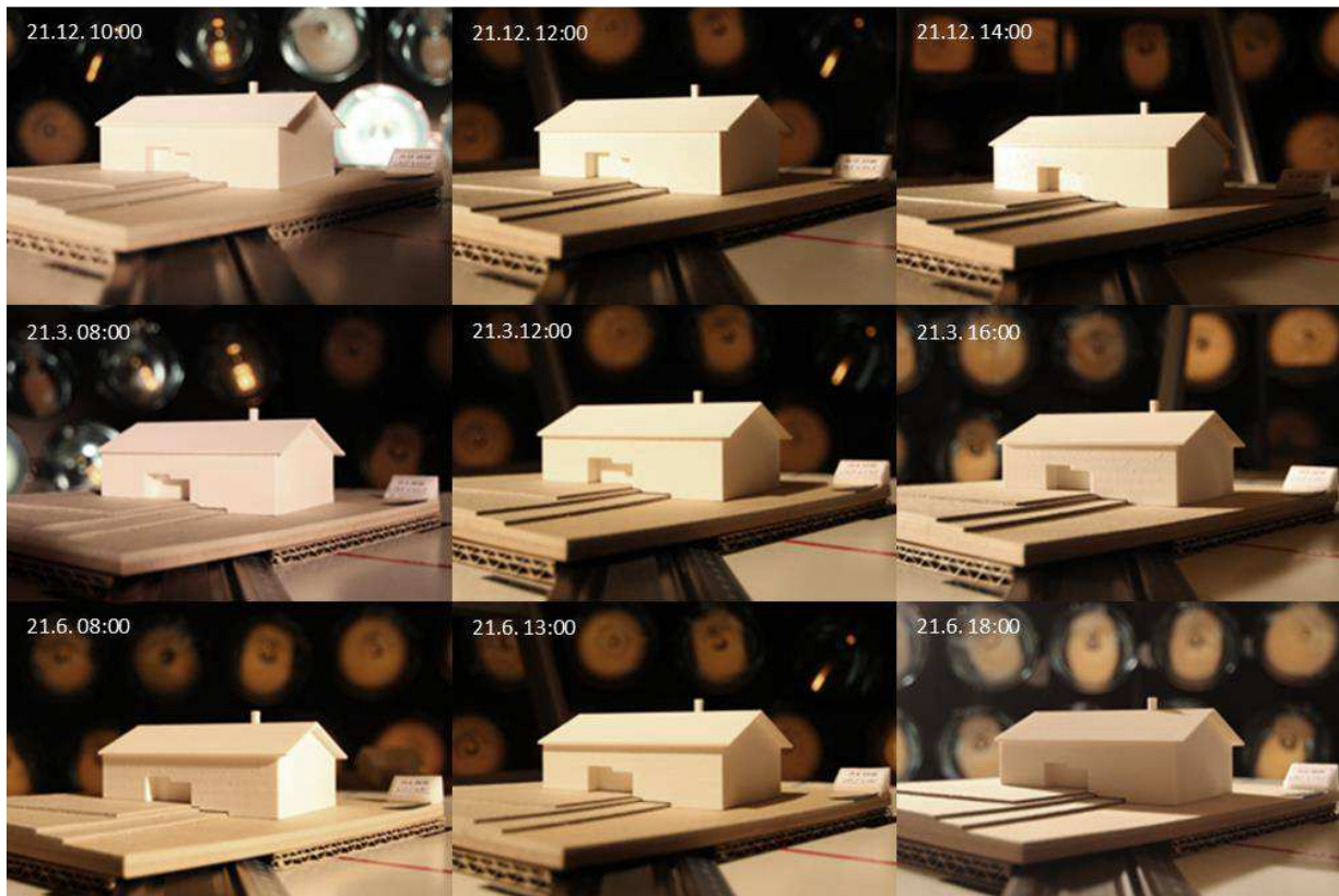
Abbildung 245: Sonnenbahndiagramm und Gebäudeorientierung (oben), Baukörper-Direktlichtstudien bei unterschiedlichen Sonnenpositionen
