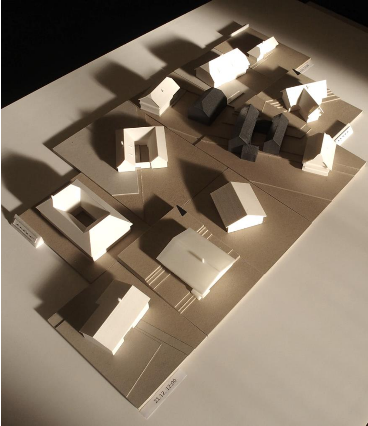
Anhang-Abbildung 42: Direktlichtsimulation des Gesamt-Gebäudemodellensembles, 21.12. 12:00 Uhr
