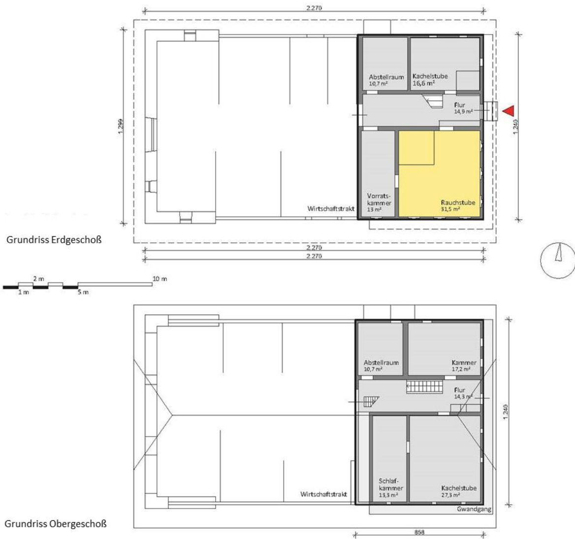
Abbildung 366: Grundrissdarstellung von Erd- und Obergeschoß des Wohnbereiches
