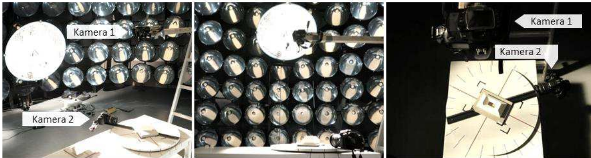
Abbildung 228: Untersuchungsaufbau im Lichtlabor und Darstellung der Kamerapositionen zur Dokumentation von Direktlichteinträgen auf die Gebäudemodelle
