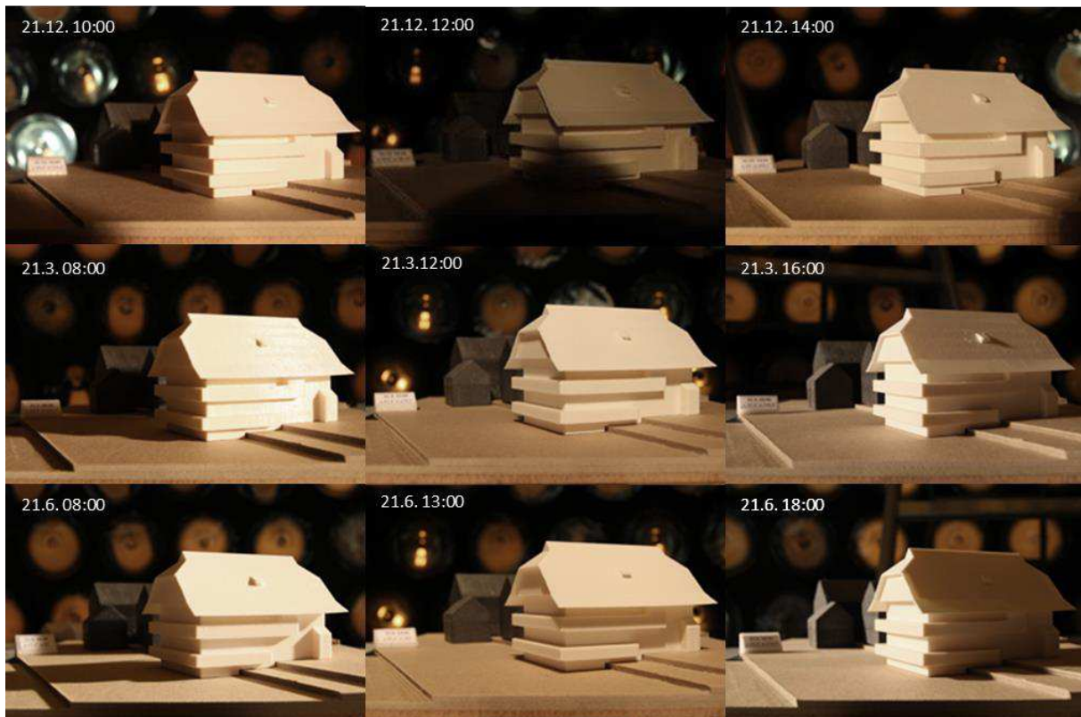
Abbildung 341: Sonnenbahndiagramm und Gebäudeorientierung (oben), Baukörper-Direktlichtstudien bei unterschiedlichen Sonnenpositionen
