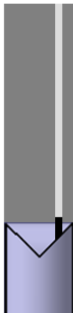
Abbildung 54: Führung des Pleuels durch eine Nut
