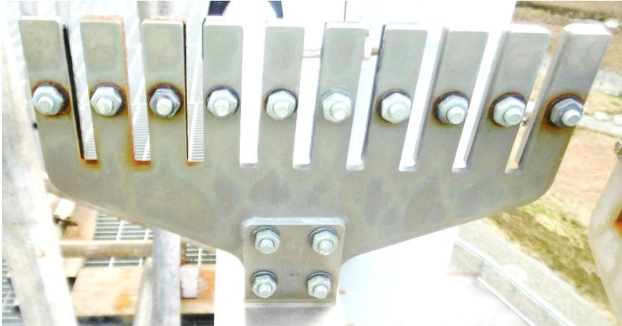
Abbildung 19 rostfreier Stahl, V3, Ansicht von innen, 3 Monate korrosiv belastet, © Total E&P UK Limited
