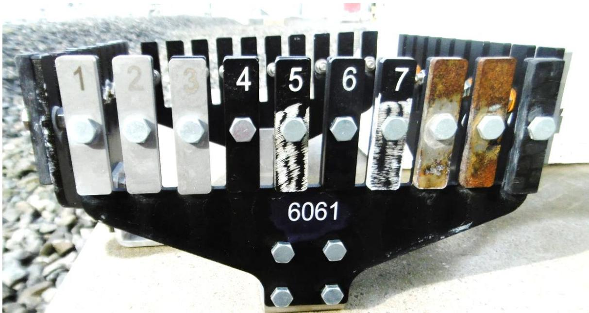
Abbildung 17: EN AW 6061, V3, Ansicht von außen, 3 Monate korrosiv belastet, © Total E&P UK Limited
