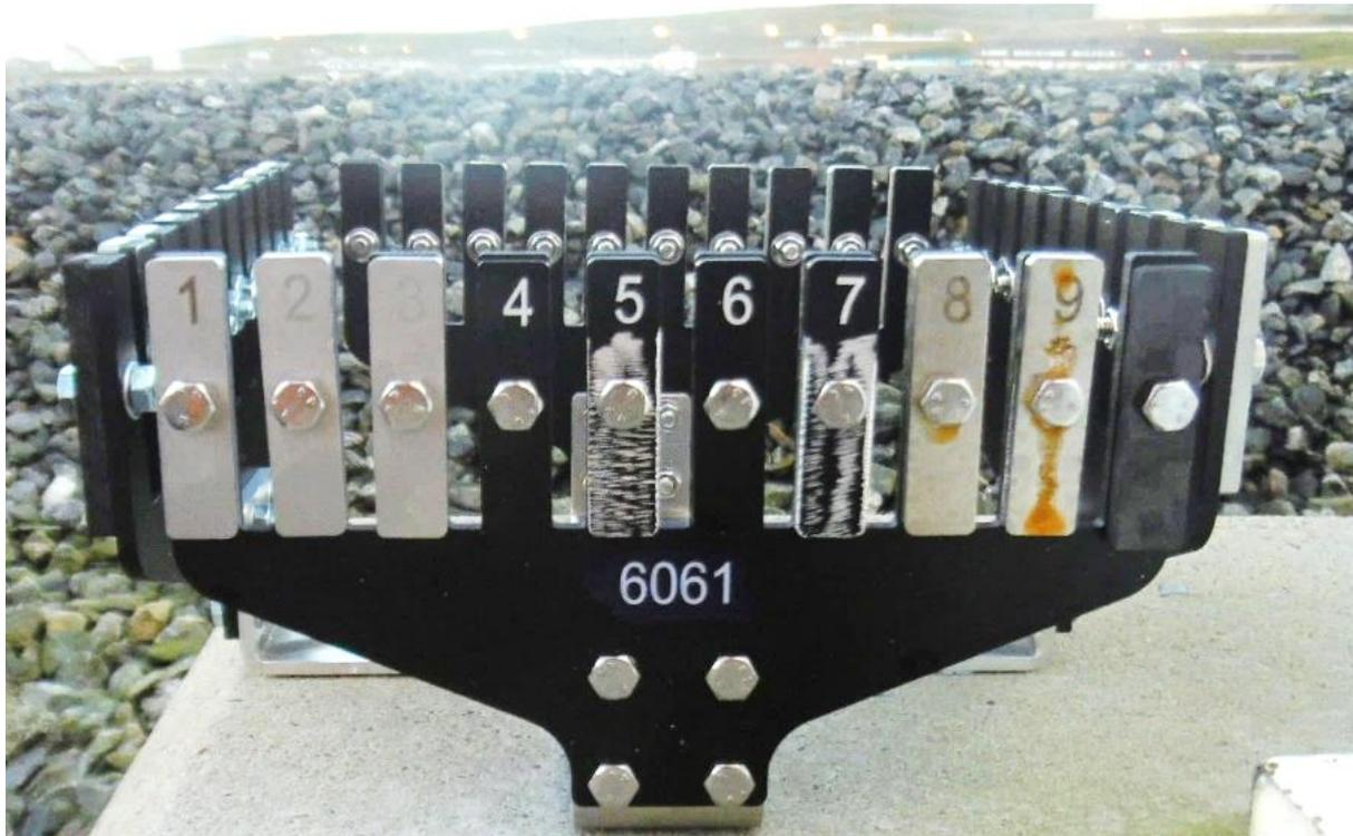
Abbildung 6: EN AW 6061, V4, Ansicht von außen, ein Tag korrosiv belastet, © Total E&P UK Limited
