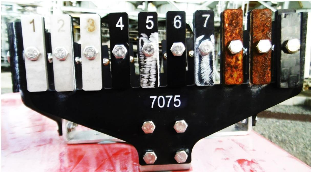
Abbildung 14: EN AW 7075, V2, Ansicht von außen, drei Monate korrosiv belastet, © Total E&P UK Limited
