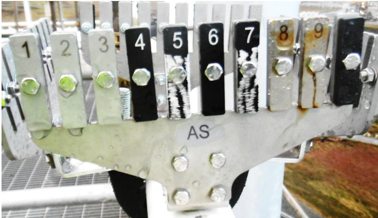
Abbildung 8: rostfreier Stahl, V1, Ansicht von außen, zwei Tage korrosiv belastet, © Total E&P UK Limited
