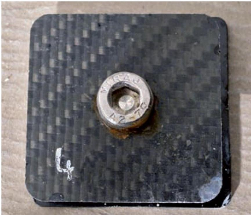
Abbildung 5: CFK-Probekörper im Verbau mit einer M8-Schraube aus rostfreiem Stahl (A2) nach korrosiver Belastung [7]
