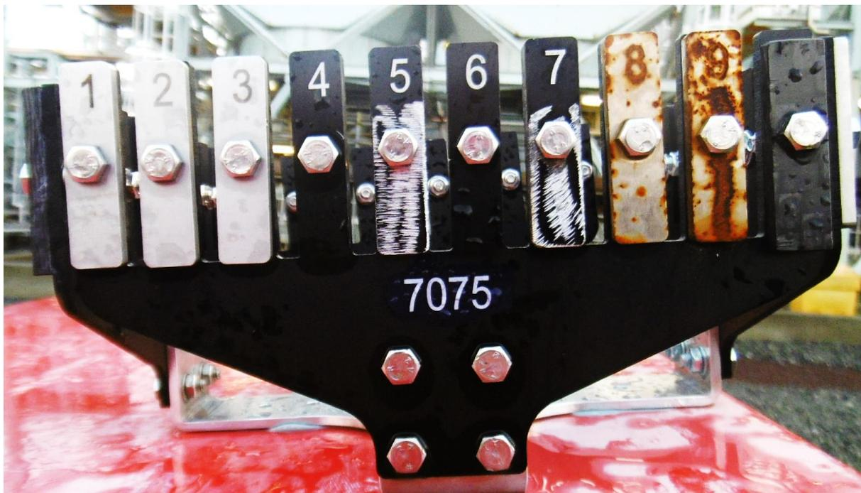
Abbildung 10: EN AW 7075, V2, Ansicht von außen, eine Woche korrosiv belastet, © Total E&P UK Limited
