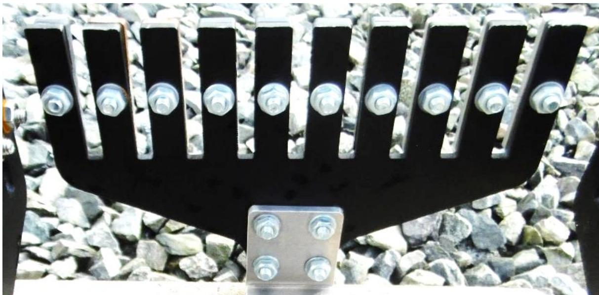
Abbildung 18: EN AW 6061, V3, Ansicht von innen, 3 Monate korrosiv belastet, © Total E&P UK Limited
