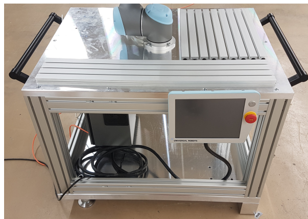
Abb. 5.3: Aluminiumtisch zur Montage des Roboterarm-Messsystems
