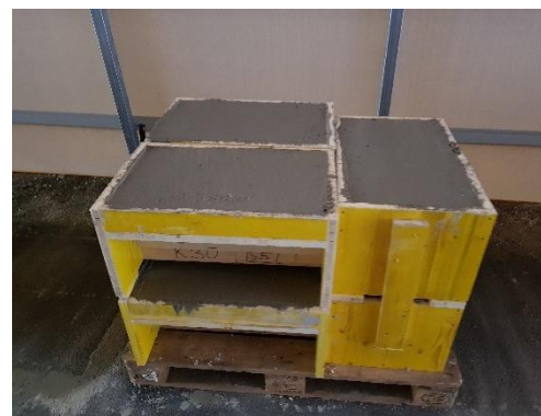
Abb. 48: Anordnung Kerne mit Kervertiefe 30mm und anschließendes Betonieren
