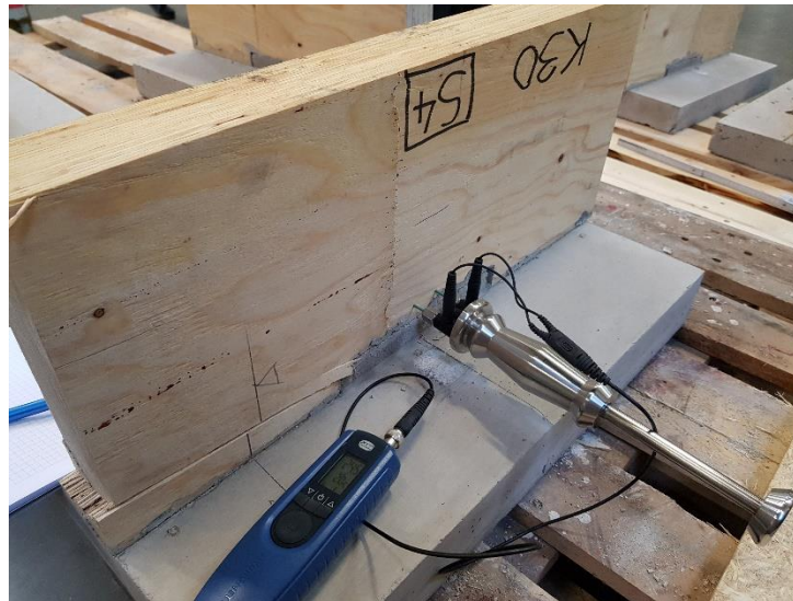
Abb. 49: Widerstandsmethode nach ÖNORM EN 13183-2 [36] am Probekörper S4 der Versuchsreihe Kervertiefe 30mm
