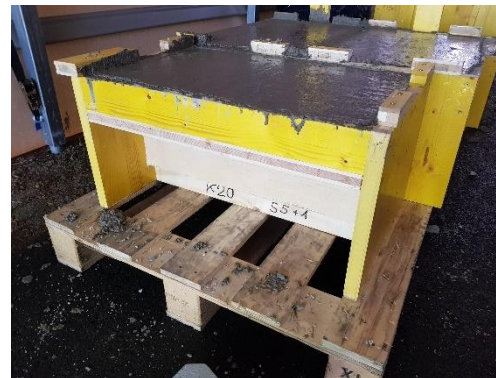
Abb. 46: Anordnung Kerfe mit Kervertiefe 20mm und anschließendes Betonieren
