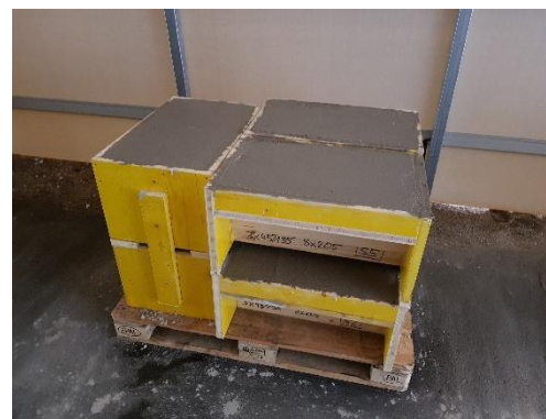
Abb. 43: Anordnung Schrauben 45°/135° und anschließendes Betonieren
