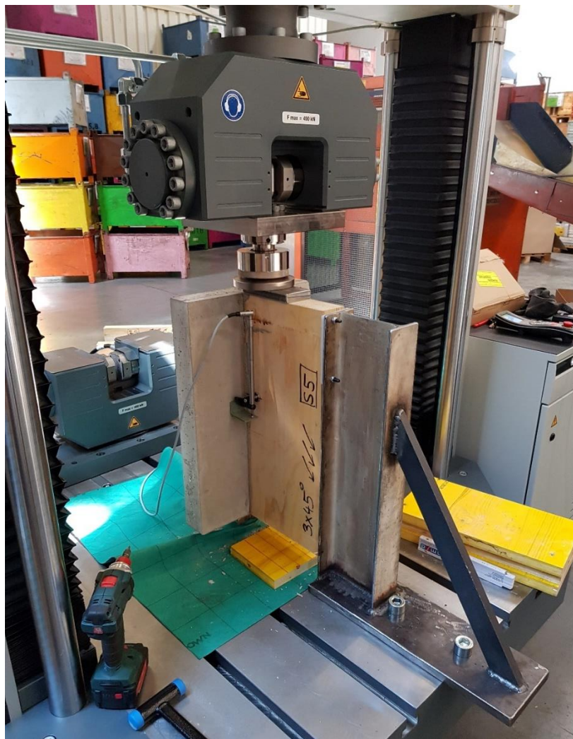
Abb. 53: Prüfkörper mit installierten Wegaufnehmern und Prüfkörperhaltevorrichtung in der Prüfmaschine
