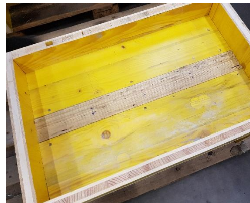
Abb. 39: Zuschnitt LVL und Zusammenbau Schalung
