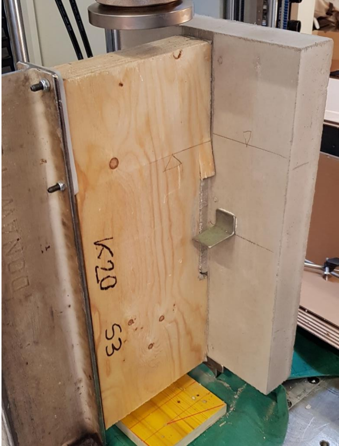
Abb. 66: Druckversagen Probekörper S3
