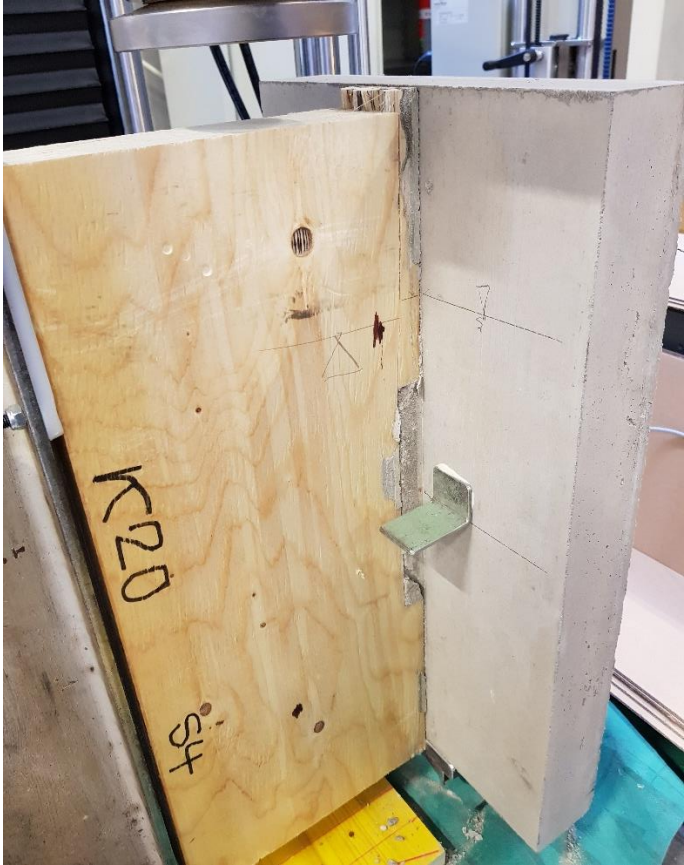
Abb. 67: Schubversagen Probekörper S4
