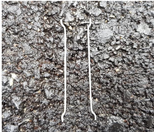
Abb. 50: Verwendete Stahlfasern im Stahlfaserbeton
