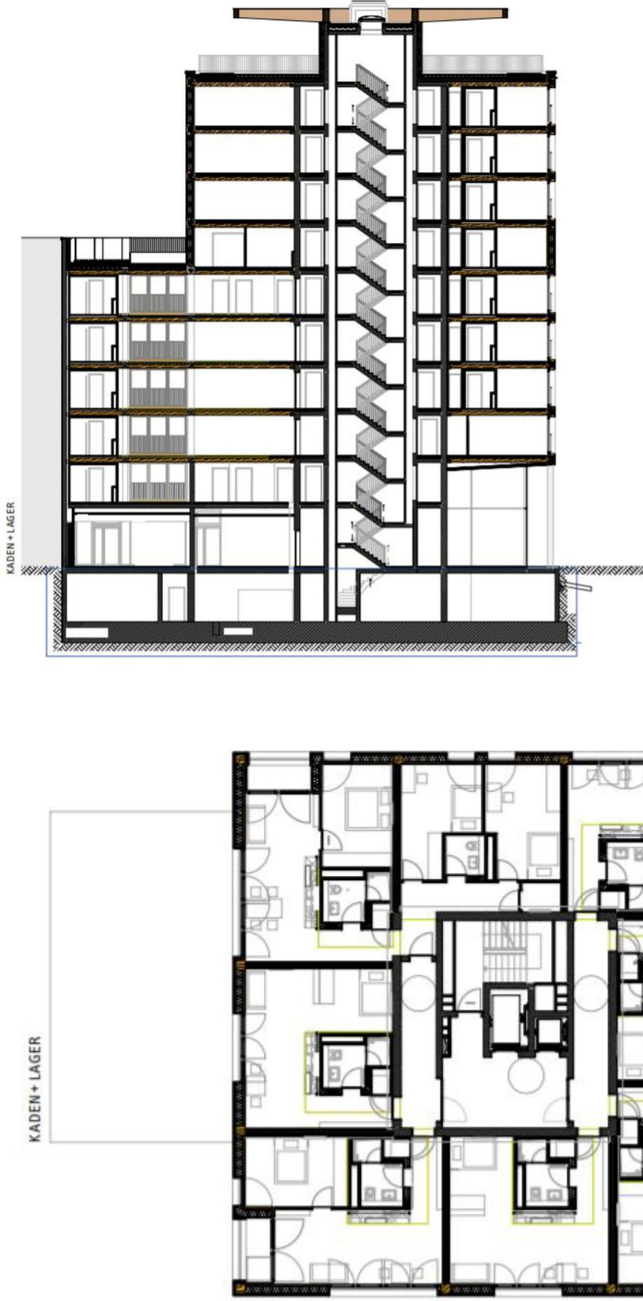
Das Tragwerk besteht aus einer Kombination aus Stahlbetonkern und –sockelgeschoss, Holzskelett und –massivbau und Stahlträgern. Für die Stützen wurde Brettschichtholz ausgewählt, für die Wände und Decken Brettsperrholzplatten. Das Erdgeschoss und das erste Obergeschoss sind im Vergleich zur restlichen Konstruktion zurückversetzt, die Überbauung wird von Stahlbetonstützen getragen.
