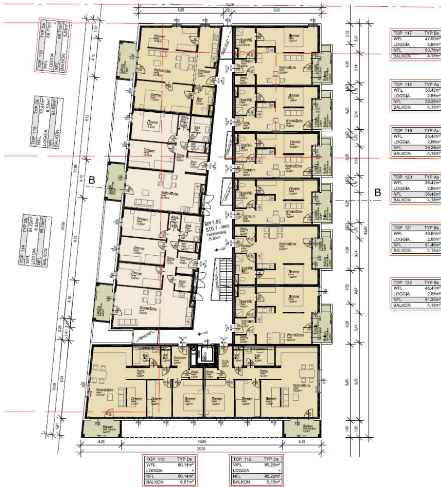
Abbildung 3.3: Grundriss 1. Obergeschoss des Wohnbaus in Stahlbetonbauweise [87]
