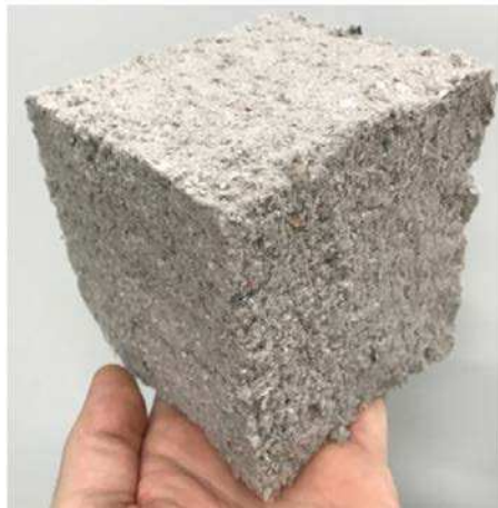
Abbildung 3.32: solide Zellulosedämmung für verbesserten Brandschutz [105]
