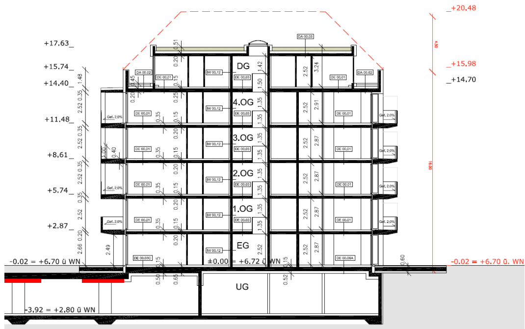
Abbildung 3.4: Schnitt durch den Wohnbau in Stahlbetonbauweise [87]
