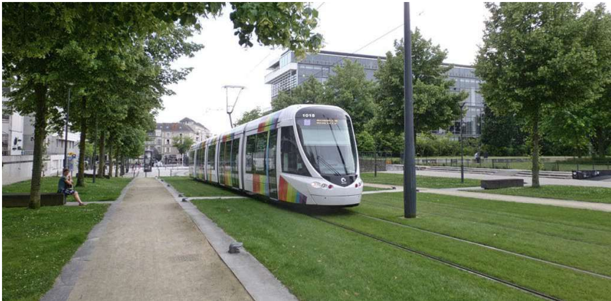
Abbildung 27: Grüne Gleise in Nantes (Frankreich) Quelle: ProCitybahn.de, 2019
