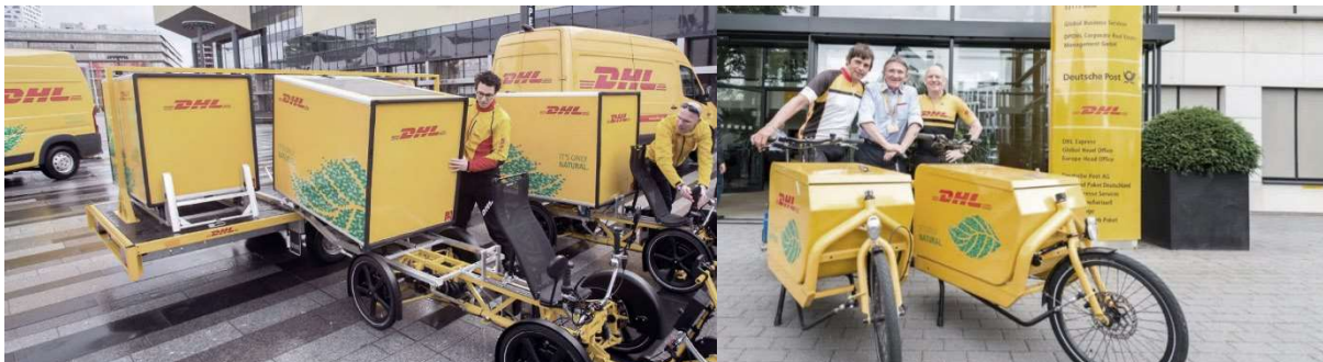
Abbildung 42: Lastenfahrräder im Zustellbetrieb (DHL) - links Auflieger für Mini-Container, rechts fix integrierter Laderaum/ Quellen: velove.se, cyclingindustry.news, 2019
