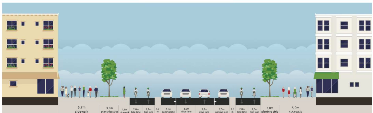
Abb. 70: Querschnitt Praterstraße 45/48, Umbau zugunsten einer Radschnellverbindung
