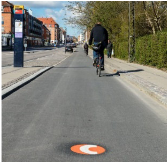
Abb. 36: Bodenmarkierung der Radschnellwege in Dänemark
