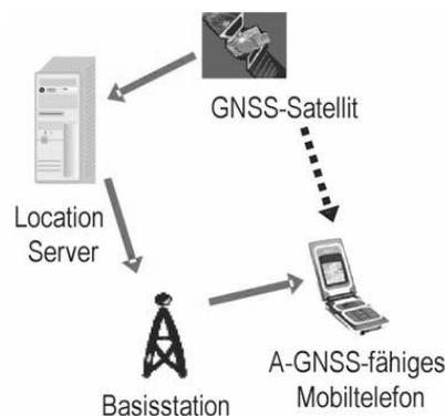
Abb. 3–19.: A-GNSS im Mobilfunknetz (Eissfeller et al., 2005)
