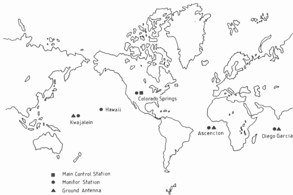
Abb. 2–36.: Die ursprünglichen Stationen des GPS-Kontrollsegments (Seeber, 1989)
