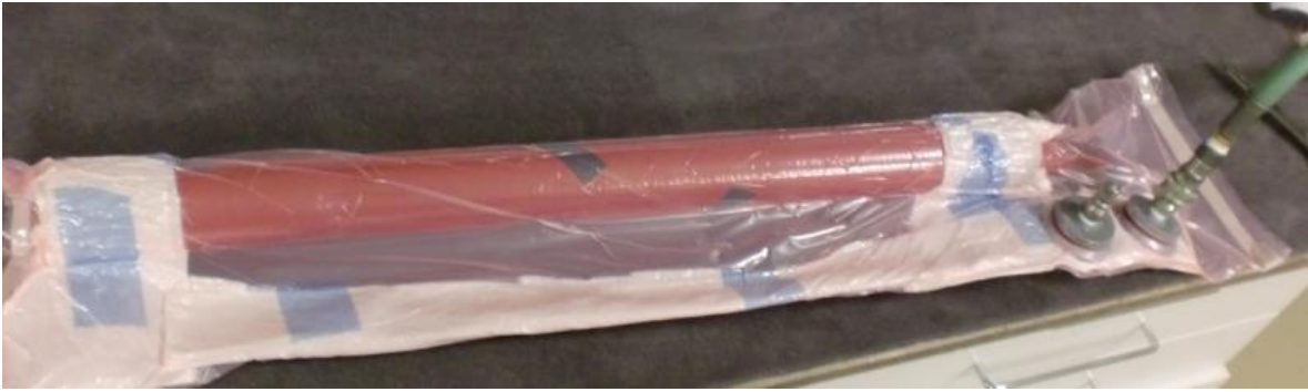
Abb. 44: Bewickelter Wickelkern mit Vakuumsack, vorbereitet für den Autoklavenhärteprozess.
