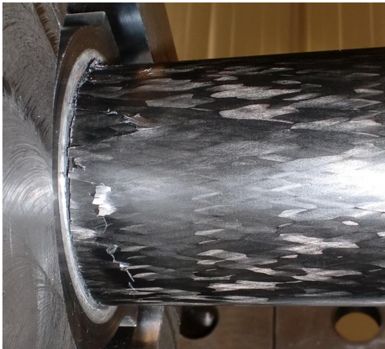
Abb. 49: Beschädigtes CFK-Standrohr an der Einspannung
