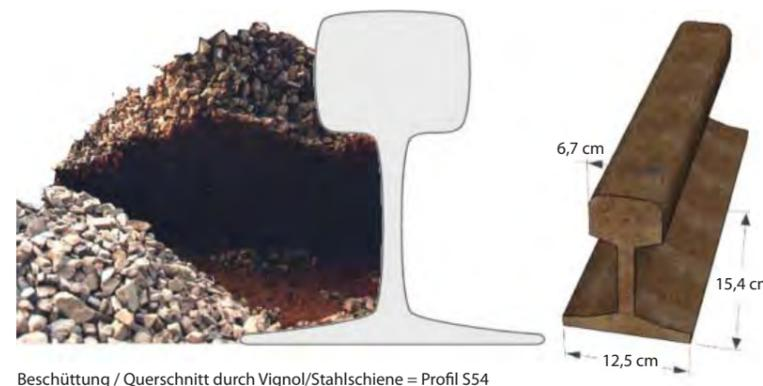
Beschüttung / Querschnitt durch Vignol/Stahlschiene = Profil S54
