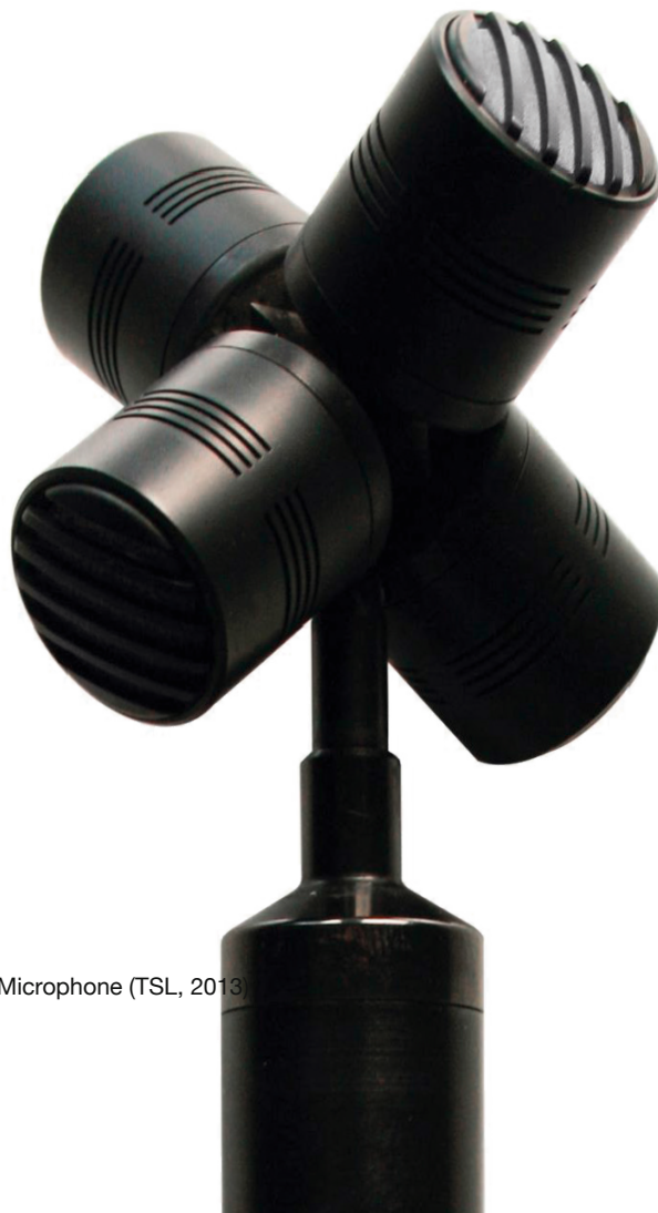
Abbildung 6.2: Ambisonics B-Format 1. Ordnung (Gerzon, 1998)
