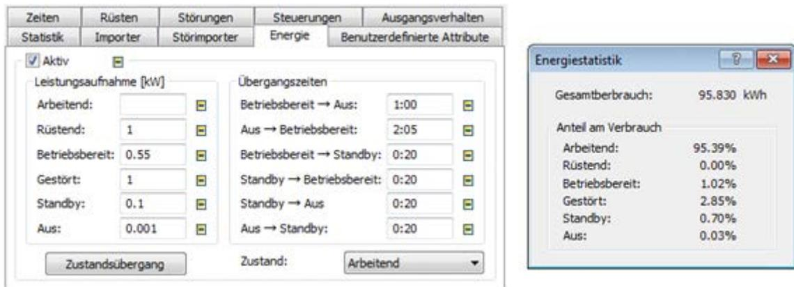
**Abbildung 52: Beispiel einer Energie-Registerkarte und der Energiestatistik für ein Materialfussobjekt in Plant Simulation**
