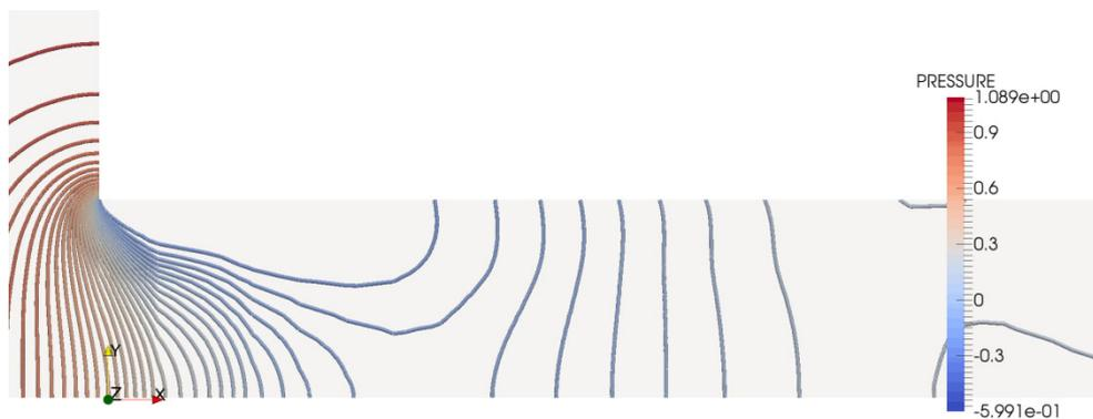
**Abbildung 5.4: Bezogener Druckverlauf,  $xy$ -Ebene,  $Re_\tau=235000$ ,  $\delta=135^\circ$ ,  $\omega=15$**
