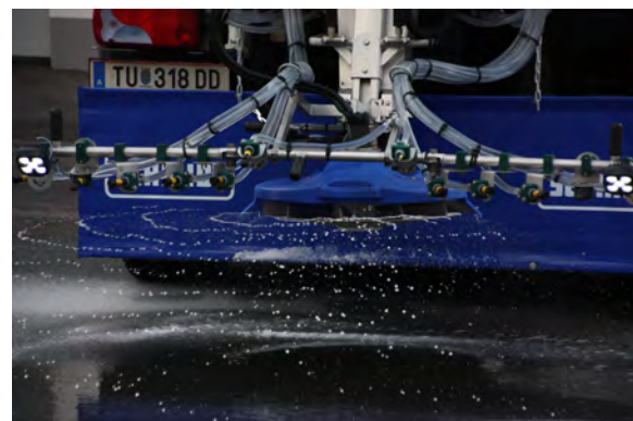
(b) Feuchtsalzstreuung FS 30 mit 70 % rieselfähigem Salz und 30 % Sole, zusammengemischt auf dem Streuteller
