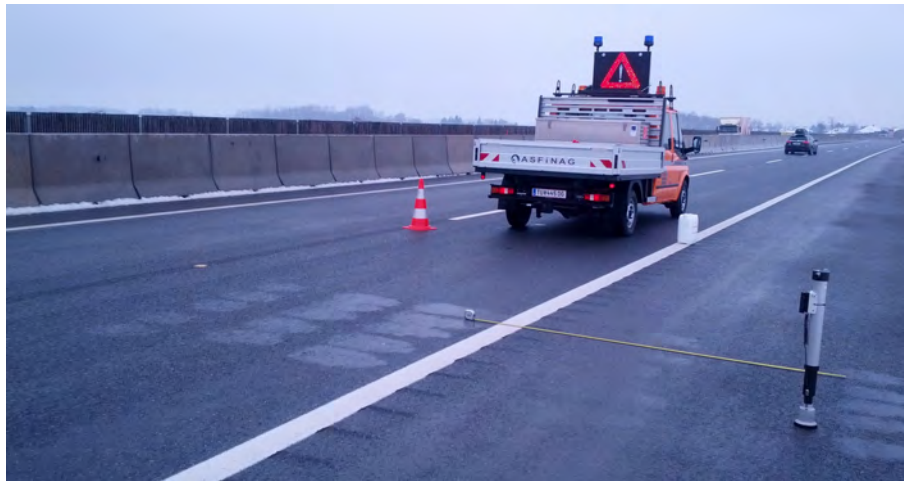
Abbildung 6.2: Messgerät SOBO20 und Messaufbau zur Messung von Restsalz auf der Fahrbahn
