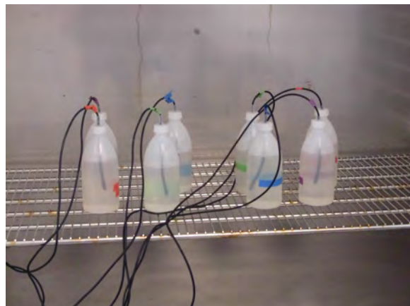
(b) Proben von Solelösungen mit eingehängten Temperaturfühlern
