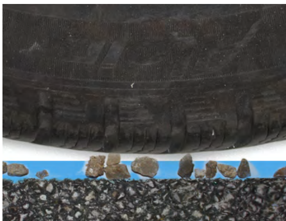
(a) Herstellung einer Verbindung zwischen Reifen und Fahrbahn durch eine Eisschicht mittels Streusplitt
