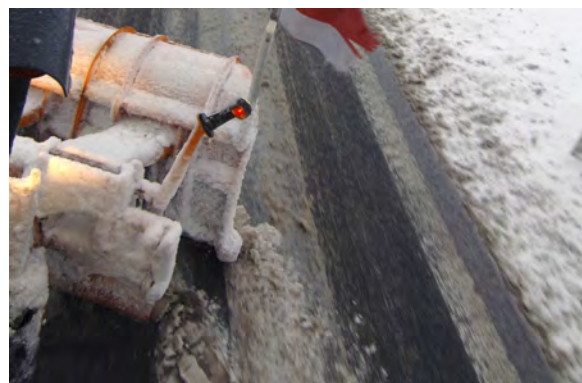
(b) Zusätzliche Räumverbesserung durch zweite Leiste (Foto: Kahlbacher)
