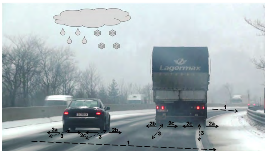
Abbildung 6.1: Verdrängungsmechanismen von Salz auf der Fahrbahn
