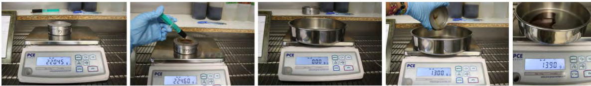
Abbildung 4.19: Arbeitsschritte bei Versuchsdurchführung: Probekörper wägen - Sole mittels Spritze aufbringen - definierte Zeit einwirken lassen - abgießen und getautes Eis und Sole wägen
