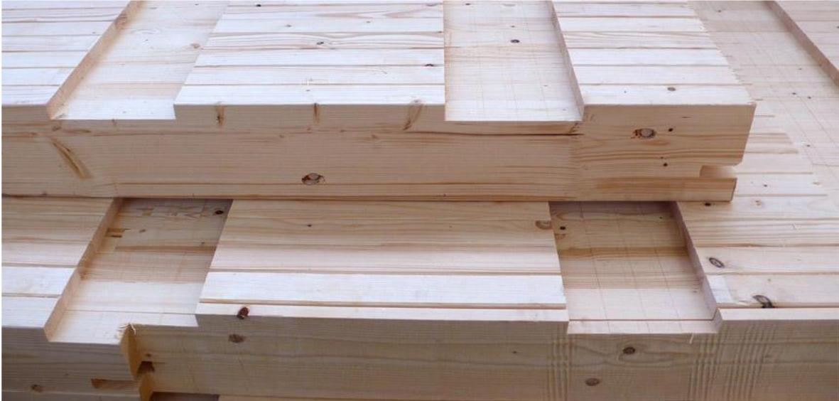
**Abb. 2.8: Kerven in einem Brettstapelelement [28]**
