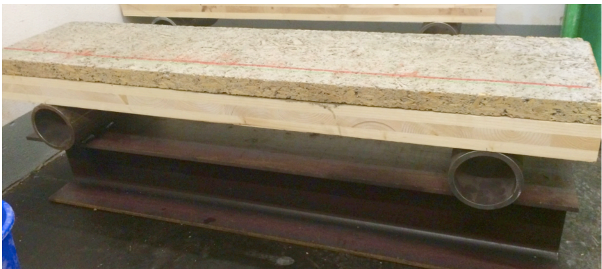
ABBILDUNG 3-5: AUFBRINGEN DER HOLZLEICHTBETONSCICHT
