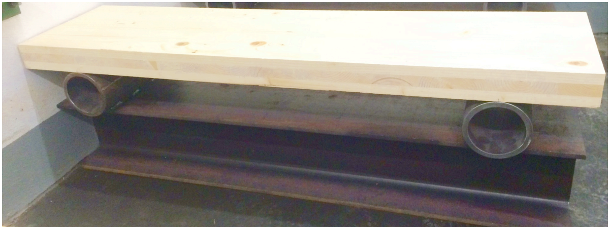
ABBILDUNG 3-4: UNTERKONSTRUKTION FÜR BAUTEILVERSUCHE
