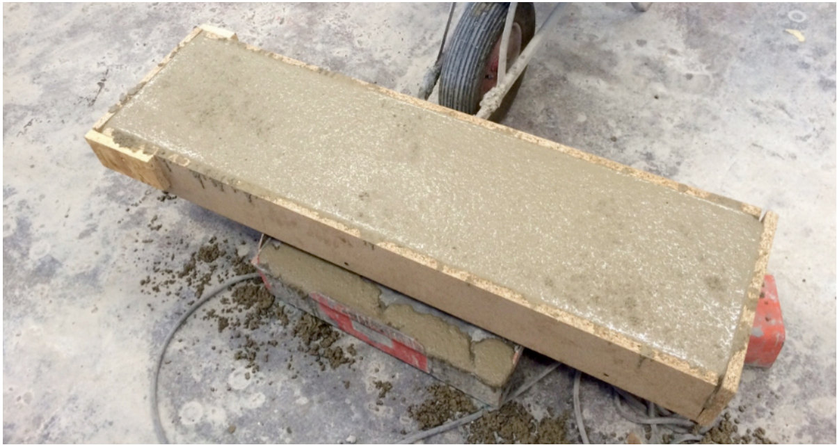
ABBILDUNG 3-8: HERSTELLUNG DER BETONSCHICHT
