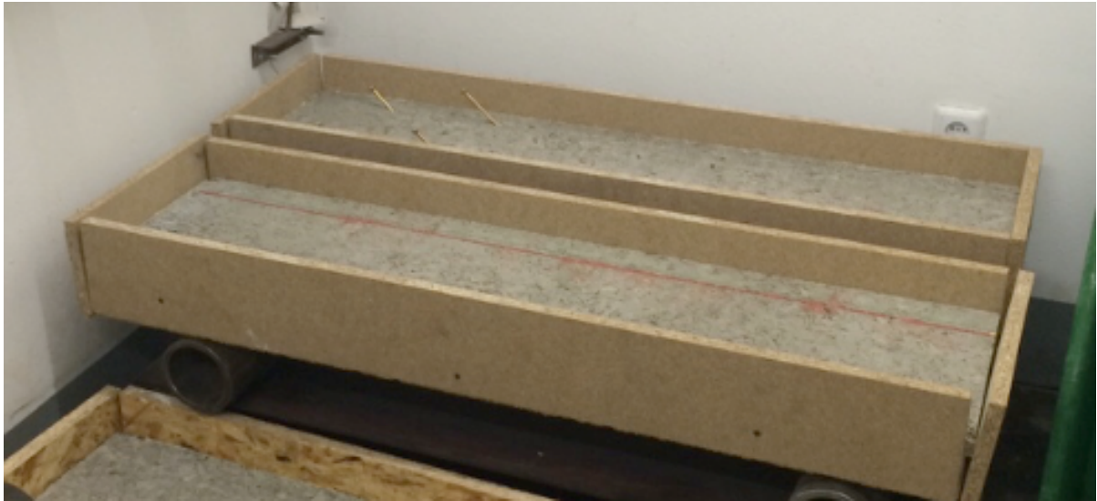
ABBILDUNG 3-7: SCHALUNG FÜR DEN BETON
