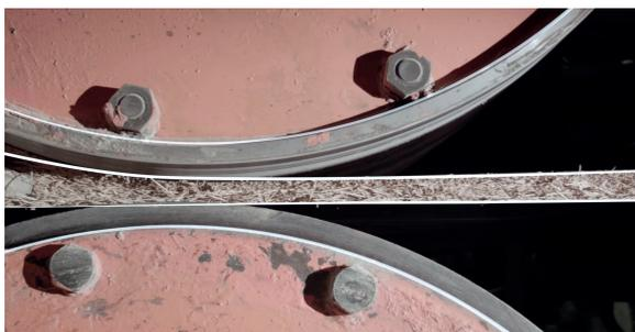
Abb. 14: Pressen des Holzwolle-Magnesit-Wasser-Gemischs zwischen den Walzen der Bandformanlage
