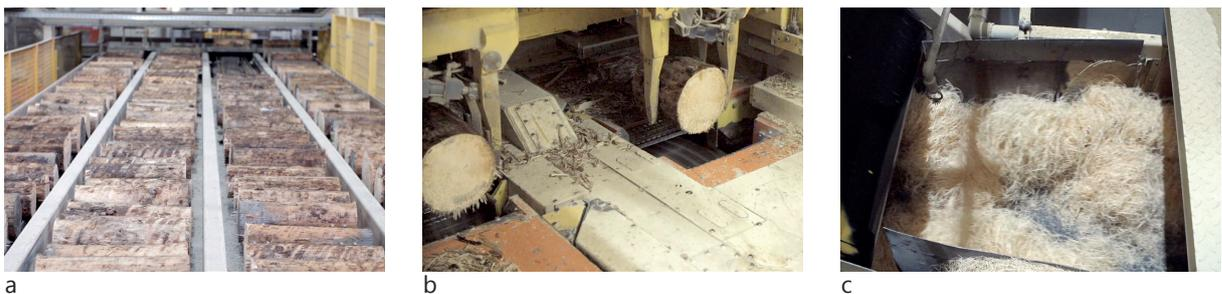
Abb. 13: Produktionsschritte Verarbeitung zu Holzwolle; a Zufuhr abgelängtes Material; b Rotationshobel; c Weitertransport Holzwolle
