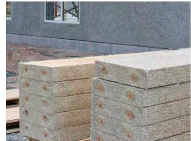
Abb. 30: Aufbau Träullit Dachelement
