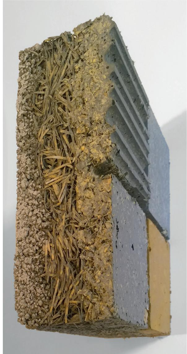
Abb. 63: Probekörper Wandaufbau mit Schichtung der Materialien
