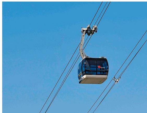
**Abbildung 2.5: Dreiseilumlaufbahn, Koblenz**
