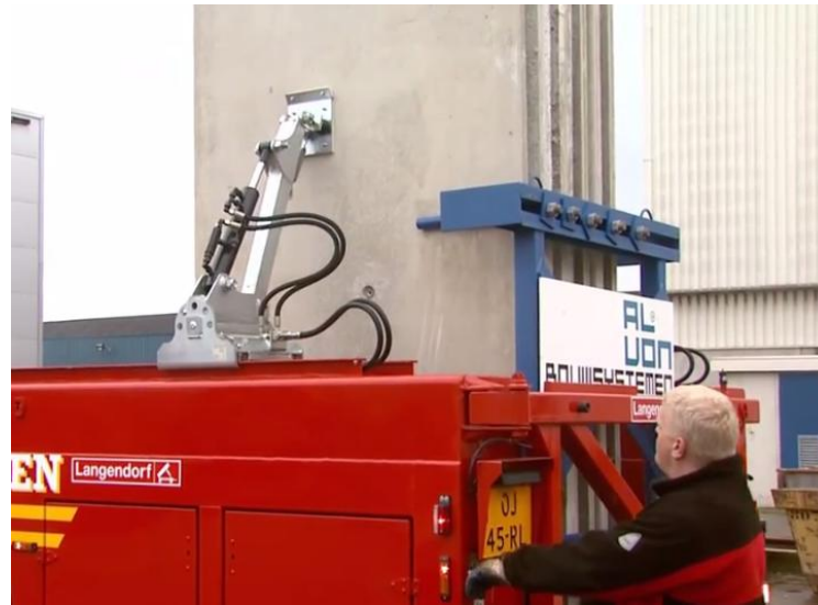
Abb. 5.34: Seitliche Ladungssicherung bei einem Innenlader [ @LAN ]
