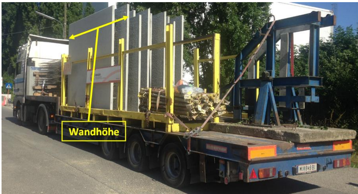
Abb. 7.6: Wandelemente auf Semitiefelader [HÜB16]
