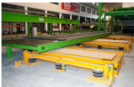
Abb. 5.15: Separate Verdichtungsstation [@SOM]
