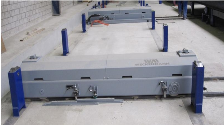
Abb. 5.4: Querhubwagen zur Querbeförderung [ @WEC ]
