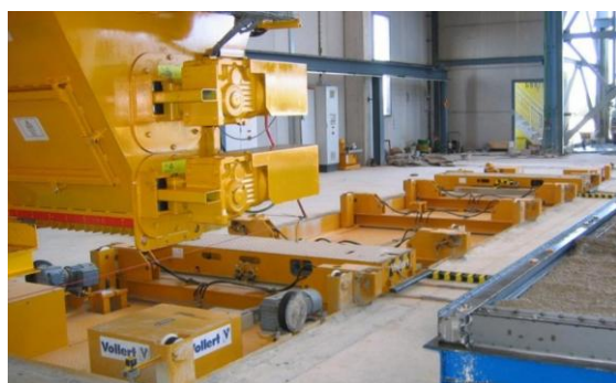
Abb. 5.16: Betonier- und Verdichtungsstation [@VOL]
