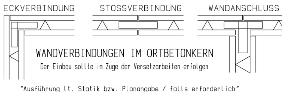
Abb. 6.22: Standardgeometrie der Stoßfugenbewehrung [OBE16]
