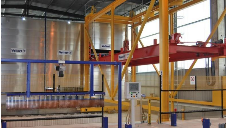
Abb. 5.17: Bodenfahrendes Regalbediengerät [@VOL]
