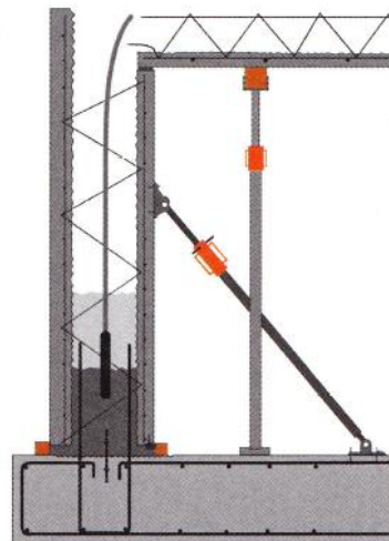
Abb. 6.25: Nachverdichten mit Rüttelflasche [HOH16]
