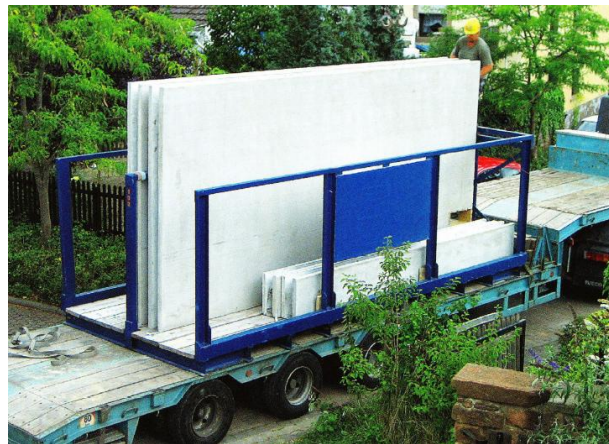
Abb. 5.26: Transportbox auf dem Semitiefvlader [KAH13]
