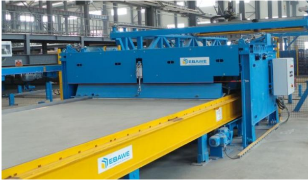
Abb. 5.6: Palettenreinigung stationär [ @EBA ]
