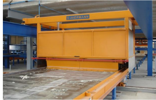
Abb. 5.7: Palettenreinigung mobil [ @AVE ]
