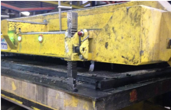
Abb. 5.19: Verstellbare Abstandhalter an dem Wendegerät [HÜB16]
