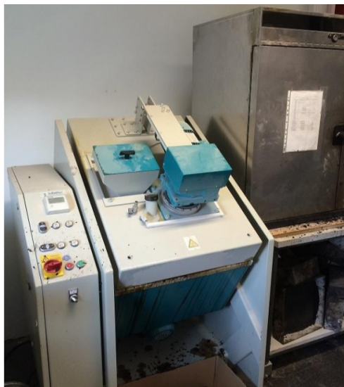
Abbildung 18: Gegenlaufzwangsmischer (links) und Wärmekammer (rechts)
