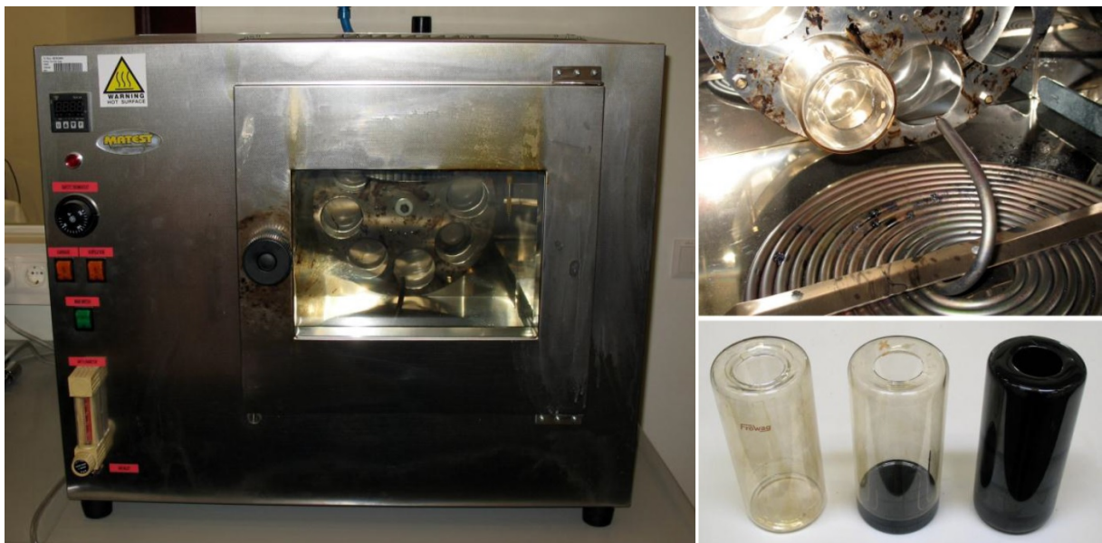
Abbildung 15: links: Rolling Thin Film Oven Test, rechts oben: Luftlanze und vertikale Flaschentrommel, rechts unten: RTFOT – Glasflaschen [8]
