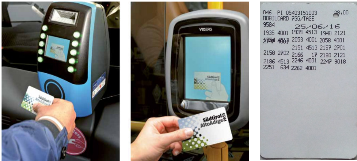
Abbildung 4-7: Links und Mitte: 2012 eingeführte kontaktlose Entwertung. Rechts: Rückseite der Mobilcard mit aufgedruckten Codes der Einstiegsstelle. Quelle: Links und Mitte: Verkehrsverbund Südtirol. Rechts: Tomberger 2016.
