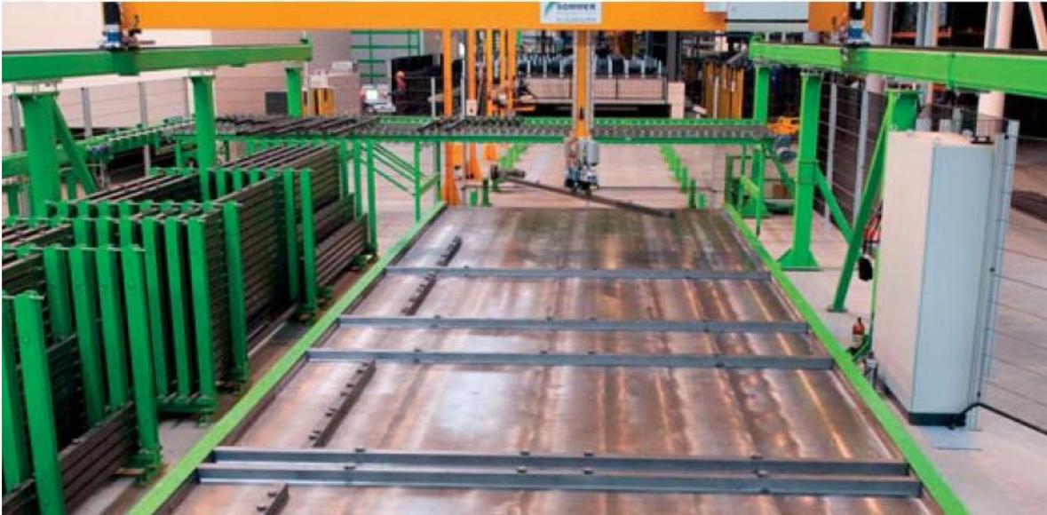
**Abb. 3.2: Setzen der Schalungen [29]**
