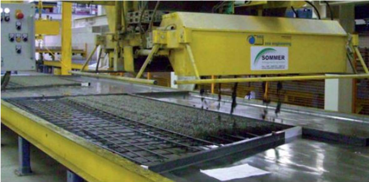
**Abb. 3.4: Betonieren [29]**
