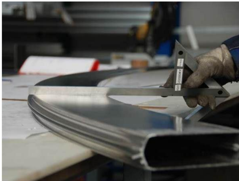
ABBILDUNG 2-2: PROFILGEOMETRIE NACH DEM BIEGEN [4]
