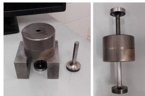
Abbildung 14: 11,27 mm Rondenwerkzeug aus Stahl
