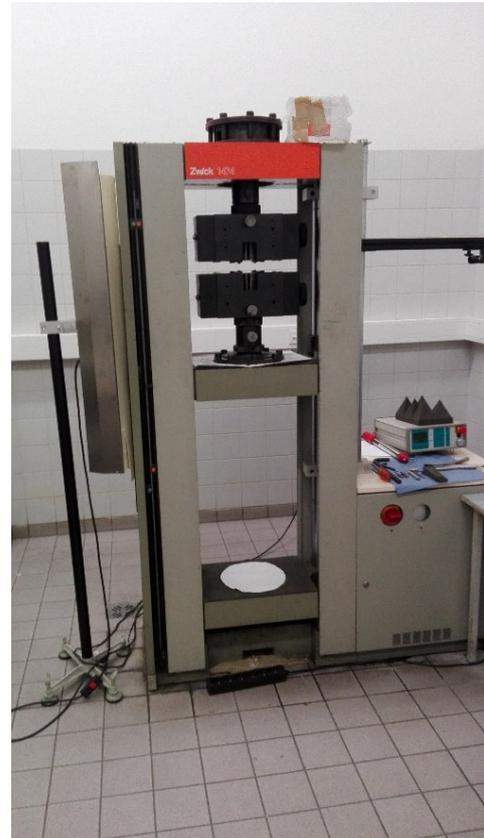
Abbildung 18: 100 kN-Prüfmaschine „1474“ (ZWICK)
