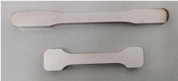
Abbildung 16: Zugfestigkeitsproben (nach DIN EN ISO 2740 und Hochdruckproben)
