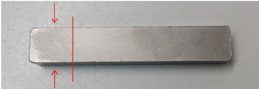
**Abbildung 9: 600 MPa verpresste Charpyproben, Abtrennung von Probenstücken zur Messung im Dilatometer (Messrichtung rot gekennzeichnet)**
