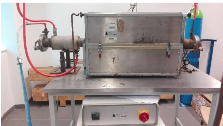
**Abbildung 7: Entwachsungs-ofen (AHT), Einschubrichtung von rechts nach links, Gasfluss gegenläufig dazu**
