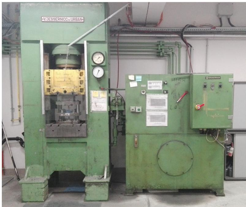
**Abbildung 15: Hydraulische 1500 kN-Pressen (Jessernigg & Urban)**
