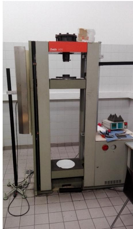
Abbildung 13: 100 kN-Prüfmaschine „1474“ (ZWICK)
