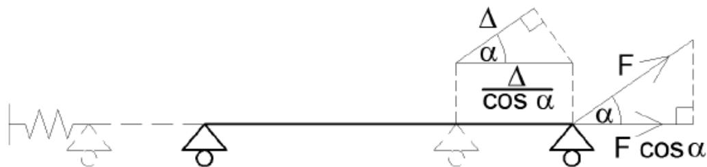
**Abb.59:** Nachgiebigkeit in Richtung der Belastung beim Satteldach [40]
