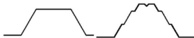
**Abb.4:** a) normales Trapezblech b) Hochprofil
