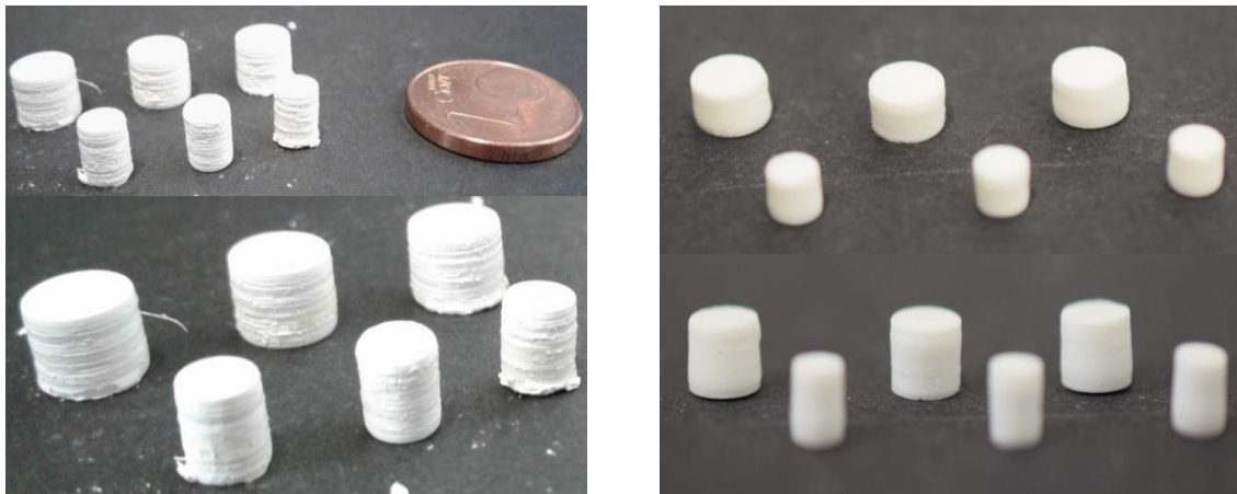
Abbildung 49: Gesinterte Bauteile der Formulierung 1 (Verhältnis Monomer:Wasser – 2:1) und der Formulierung 2 (Verhältnis Monomer:Wasser – 1:2)
