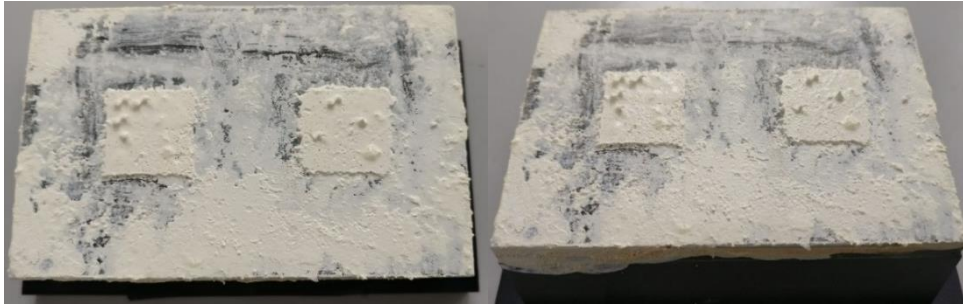
Abbildung 69: Druckversuch der gefüllten Diacrylat Hydorgelformulierung mit einem zusätzlichen Anteil von 70 % (m/m) Zirkonipulver; als Photoinitiator wurden die wasserdispergierbaren Ivocerin Kolloide verwendet
