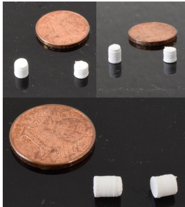
Abbildung 53: Gesinterte Bauteile der gefüllten Diacrylat Hydrogelformulierung mit einem Monomer: Wasser Verhältnis – 1:1
