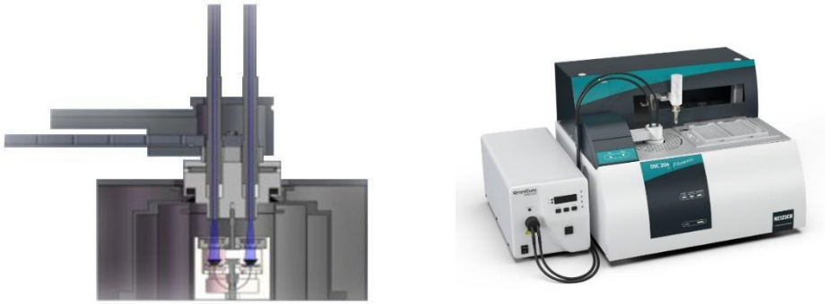
Abbildung 22: Links Messzelle der Photo-DSC mit Referenz- und Probeschälchenmesskammer; rechts Netsch DSC 204 F1 mit Autosampler und Omnicure Serie 2000
