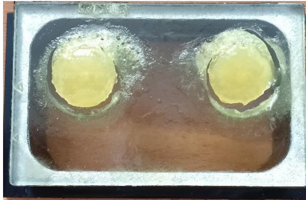
Abbildung 67: Druckversuch von Zylindern der gefüllten Vinylester Hydrogelformulierung
