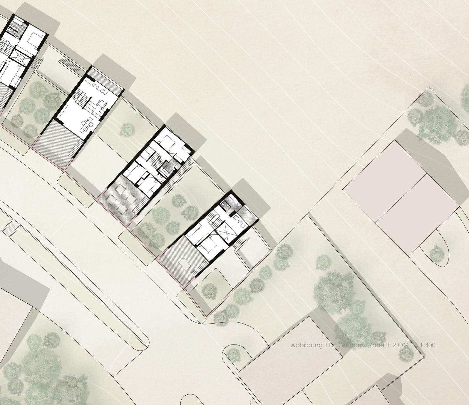
Abbildung 117: Grundriss: Zone II: 2.OG. M 1:400
