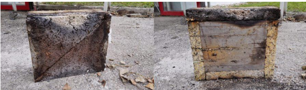
Abbildung 55: Brandschädigung in der Ebene zwischen beiden Holzleichtbetonplatten (links) und an der Holzoberfläche (rechts)
