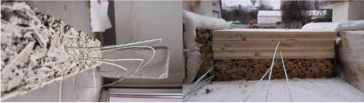
Abbildung 65: Versuchsaufbau zur Modellierung der zeitlich veränderlichen Temperaturverteilung im Querschnitt
