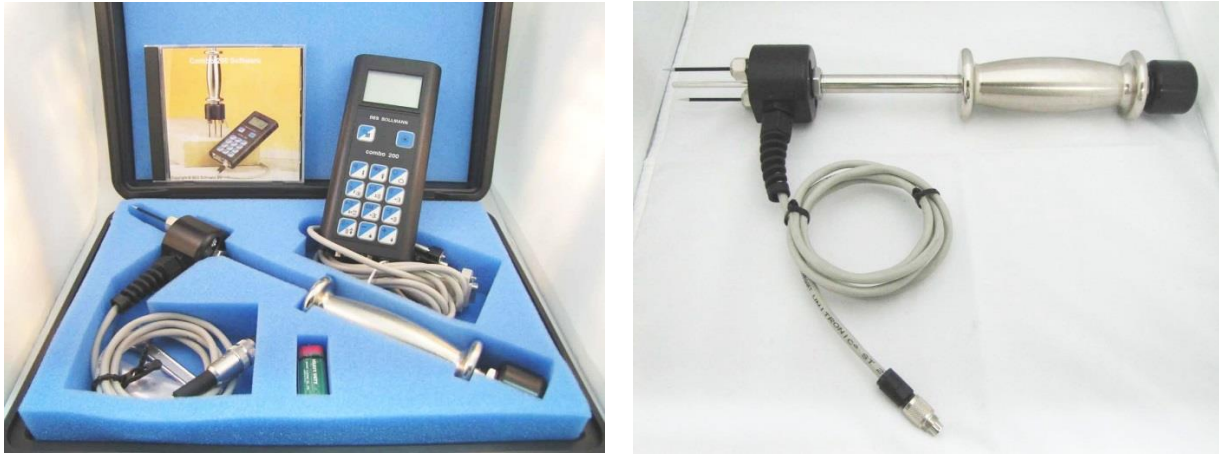
Abbildung 23: Handkoffer Feuchtemessgerät BES Bollmann 200 (links) und Hohlkammersonde mit 2x 60mm Nadelelektroden (rechts)
