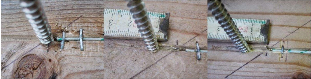
Abbildung 57: Thermoelemente im Schraubebereich, Messung direkt an der Schraube (links), in 5mm Entfernung (mitte), in 10mm Entfernung (rechts)
