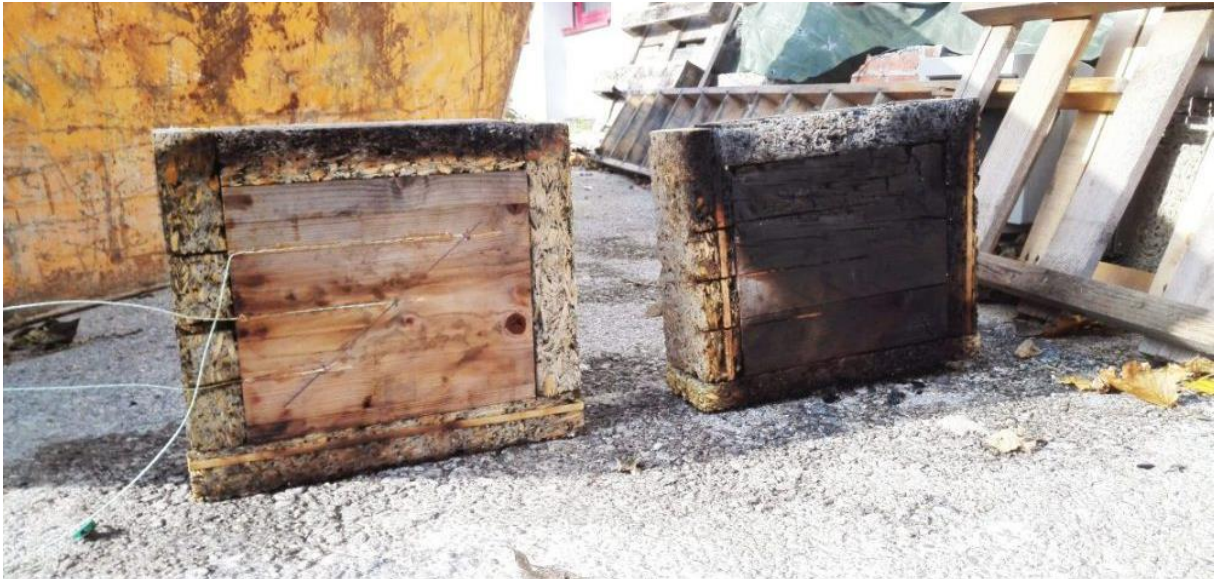
Abbildung 49: Holzoberfläche zweier Probekörper nach der Brandbeanspruchung entsprechend der ETK,
