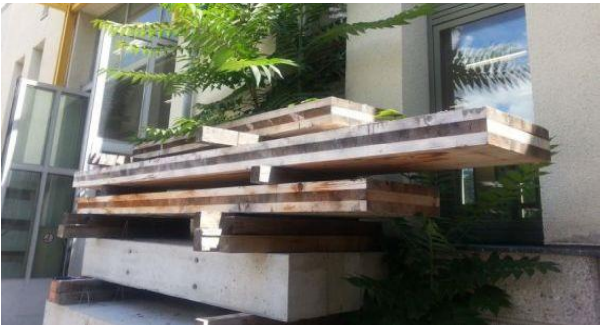
Abbildung 22: Brettsperrholzbinder als Ausgangsmaterial für die Probekörper bei der Freiluftlagerung
