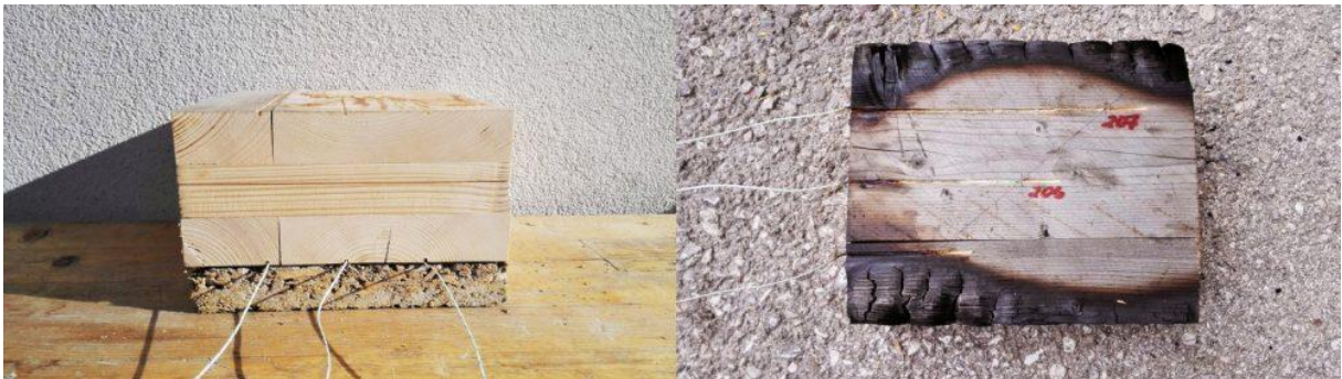
Abbildung 42: Probekörperaufbau der Vorversuchsreihe 1 vor Versuchsbeginn (links) und Holzoberfläche mit seitlicher Verkohlung nach 60 Minuten Brandeinwirkung (rechts)
