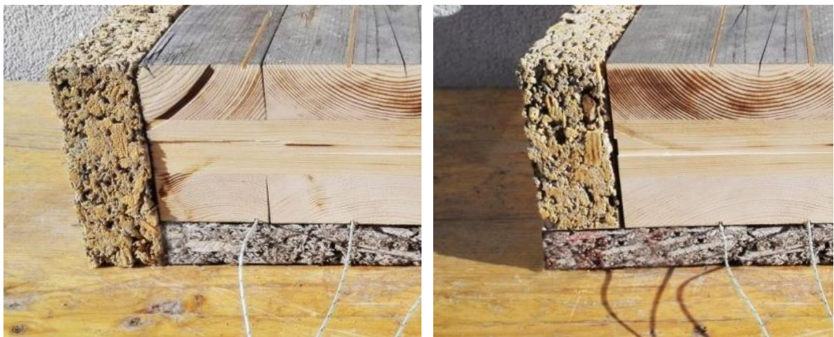
Abbildung 43: Randeinfassung der Probekörperaufbauten von Vorversuchsreihe VV2 (links) und Vorversuchsreihe VV3 (rechts) im Vergleich
