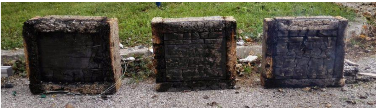
Abbildung 44: Verkohlungsbild der Probekörperaufbauten VV2 (links) und VV3 (2x rechts)
