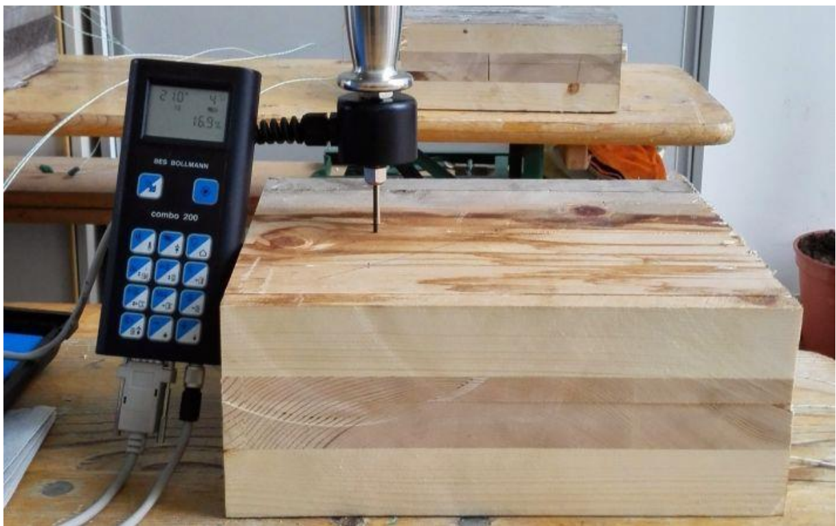
Abbildung 24: Feuchtemessung BES Bollmann 200 am Probekörper mit eingeschlagener Hohlkammersonde
