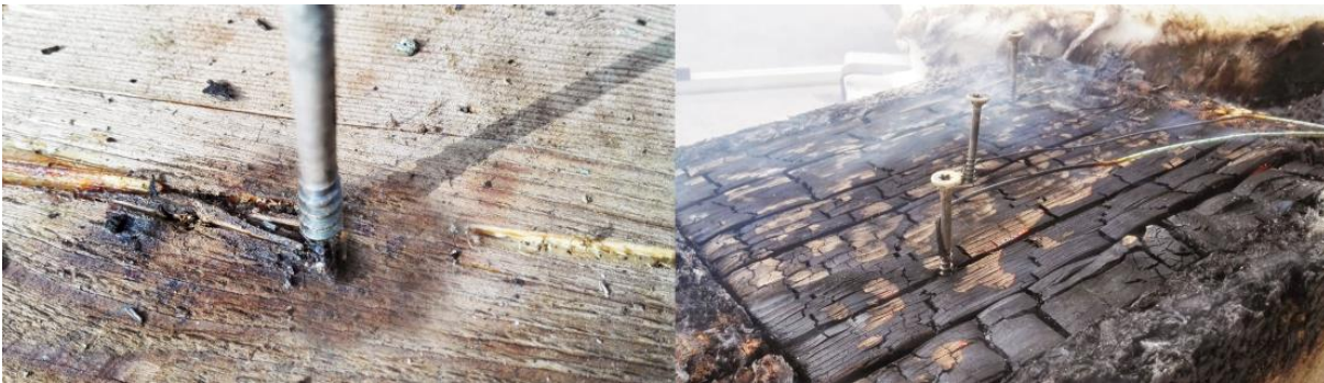
Abbildung 58: Leichte Holzverfärbungen im Schraubenbereich nach 60min Brandbeanspruchung (links) und Verkohlungsbild nach 90min (rechts)
