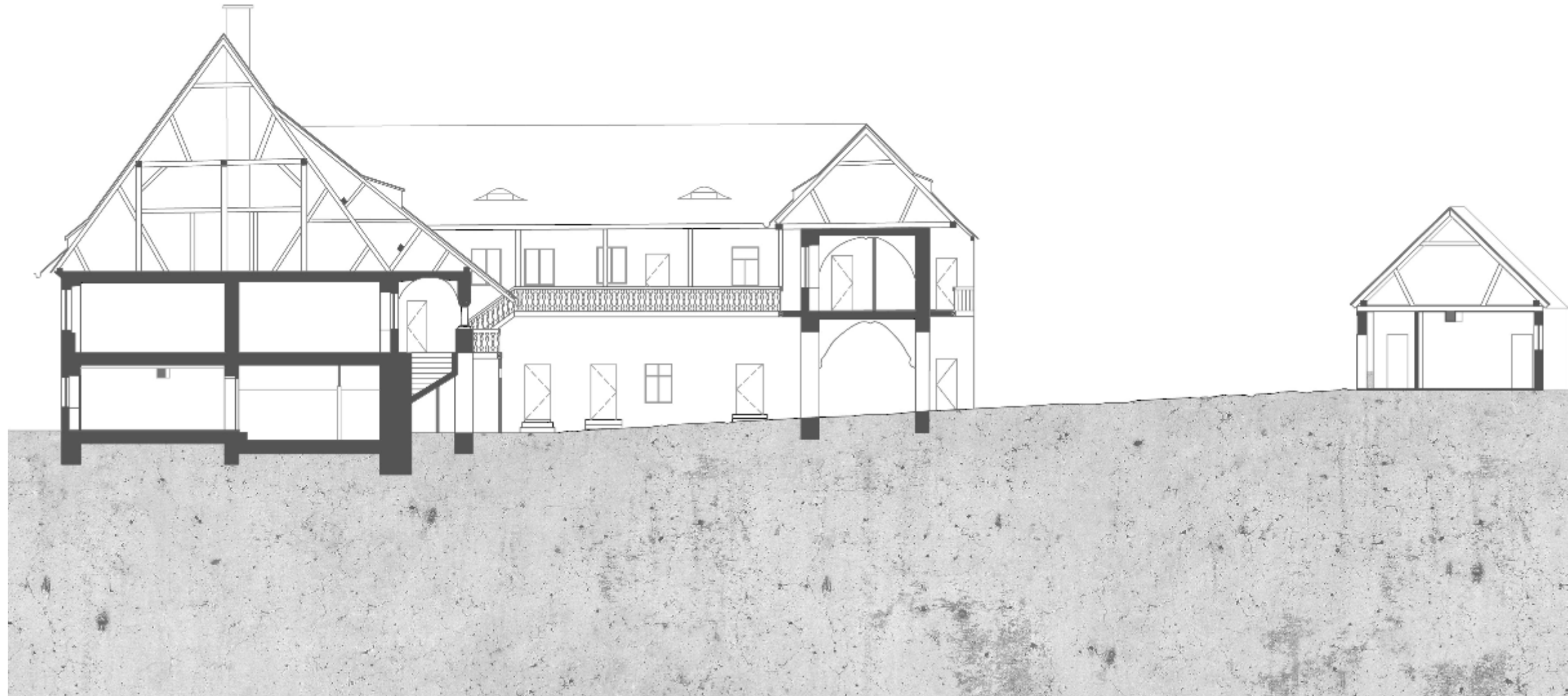
Abb. 25 | Längsschnitt durch den Haupttrakt A | M 1:200
