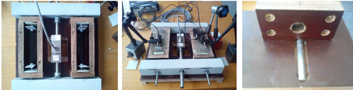
Abbildung 3.7: Aluminium-Platten zur Dehnmessung (links), Dehnmessung (mitten) und Stahlstangen zur Verminderung der Reibung (rechts)
