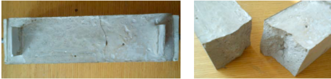
Abbildung 3.13: Riss im Probekörper beim Versuch 2-03
