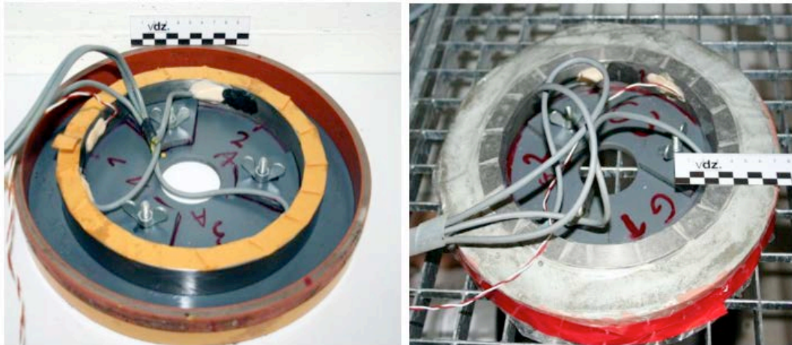
Abbildung 2.16: Aufbau eines Ring-Tests von Eppers [33], vor (links) und nach dem Gießen (rechts)
