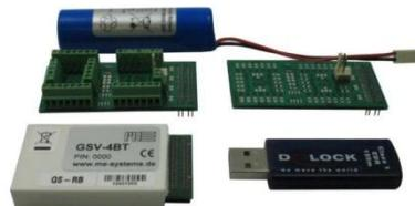
Abbildung 7: Messverstärker GSV-4BT (mit Akkumulator für den Größenvergleich)
