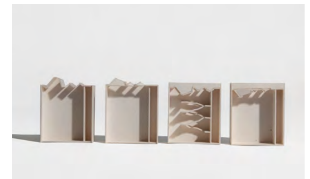
Arbeitsmodelle 1:333, Lichtstudien verschiedener Sheddach-Konstruktionen
