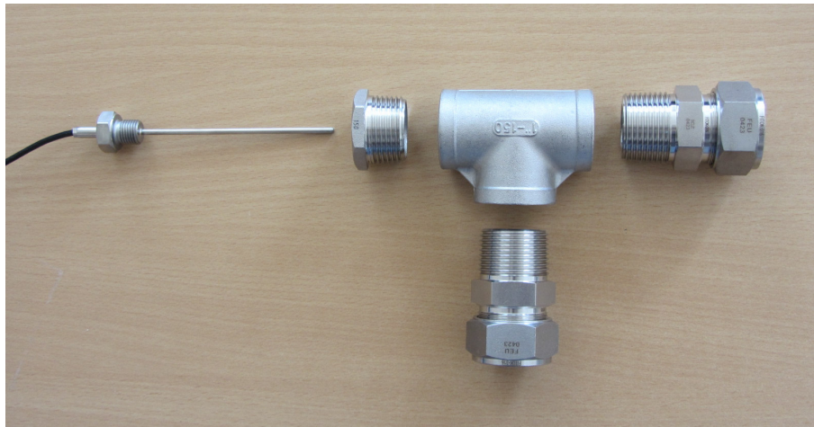
Abbildung 5.5: Widerstandsthermometer, Gewintheadapter, T-Stück mit Innengewinden und Klemmverbindungen.
