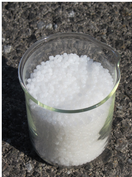
Abbildung 3.2: Verwendetes HDPE in Granulatform.
