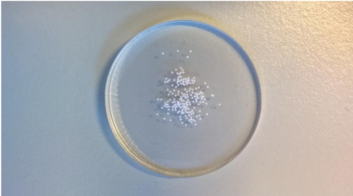
Abbildung 64: Zeolithkugeln auf einem Plexiglasreflektor
