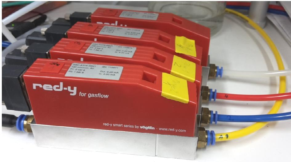
Abbildung 3.1: Verwendete Mass Flow Controller
