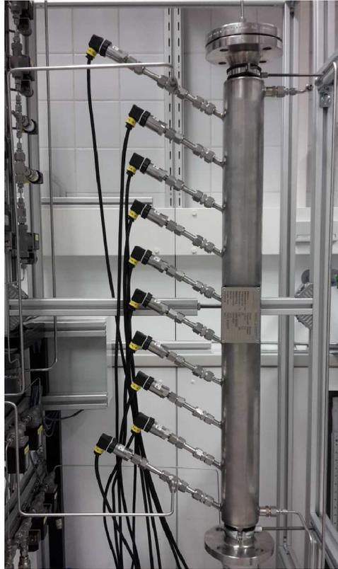
Abbildung 3.18: Adsorber ohne Wärmedämmung
