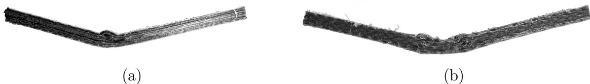
Abbildung 4.11.: (a) Biegeprobe aus verstärktem PP-Gelege in 0°-Richtung; (b) Biegeprobe aus verstärktem PP-Gewebe in 0°-Richtung
