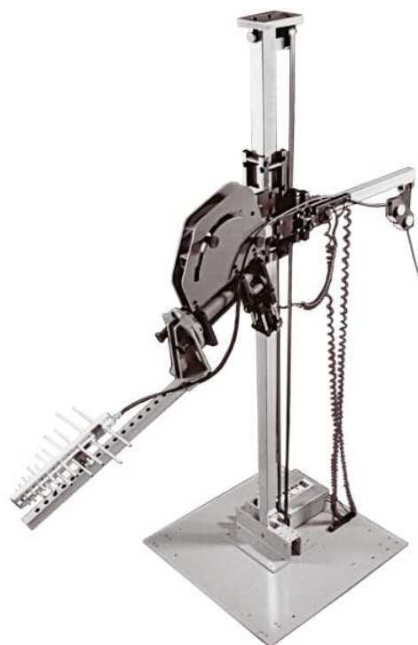
Bild 6-22: Bore-sight Masten von a) Sunol Sciences [98] b) ETS EMC Test Systems [42]
