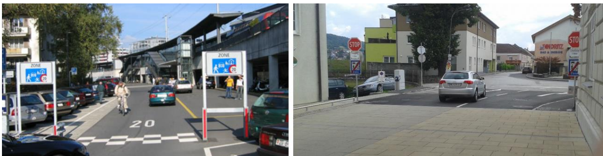
Abbildung 94: links: „Portal“ am Beginn einer Begegnungszone in der Schweiz (Käfer et al. 2011, 21; Foto: Thomas Schweitzer), rechts: kontrastreicher Übergang zwischen Begegnungszone und herkömmlichem Ortsgebiet in Pöchlarn, Niederösterreich
